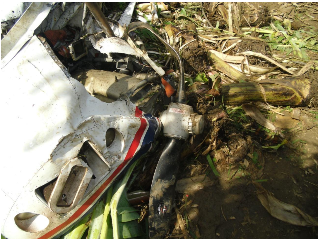
Nótese la deformación de las hélices que indican potencia del motor al momento del impacto.
