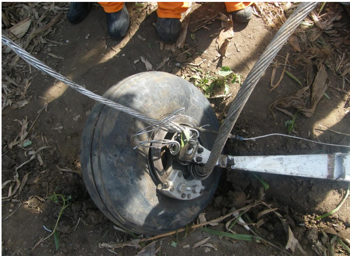
Notese el cable del tendido electrico sujeto al tren de aterrizaje.
