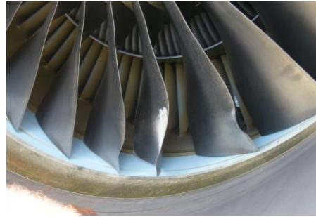
Nótese los alabes del fan dañados producto del impacto con el ave.
