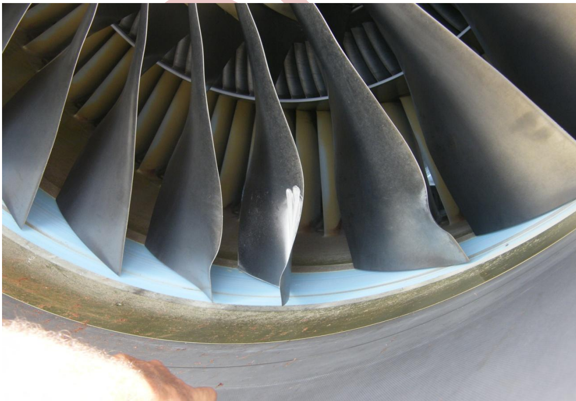
Foto de los daño en los alabes.
