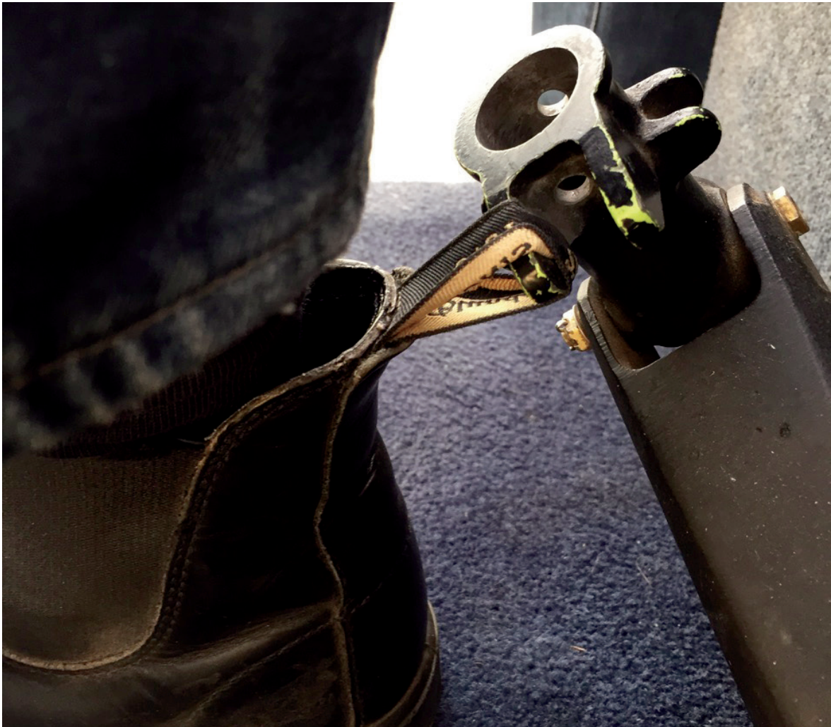
Figuur 3: Bij verkeerd plaatsen van schoenen met lus, kan de lus achter de bevestiging van de cyclic blijven hangen. (Bron: Ryfas helicopters)
