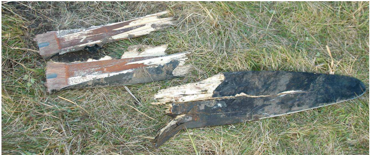
Attēls 7b. Gaisa kuģa propellera lāpstiņu fragmenti
