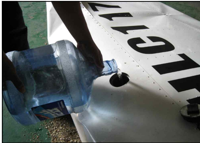
[그림 11] 연료탱크 누설 시험 장면
