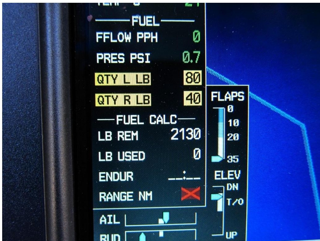
Slika 8. – Indikacija količine goriva u spremnicima (žuta polja)
