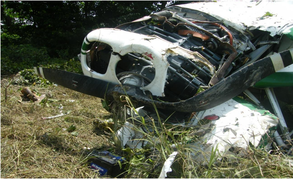
Nótese la deformación de la parte delantera del avión, producto de las gravedades positivas (Gs), absorbidas por la estructura, al impactar con la superficie.
