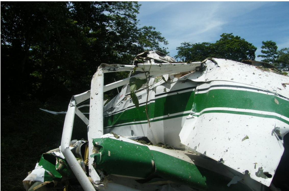
Soporte del ala derecha deformado, producto del impacto con los arboles.
