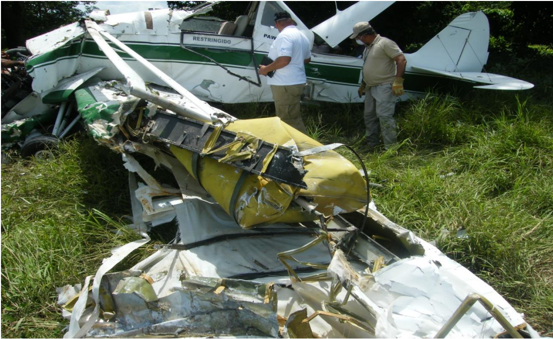
Condición final del ala izquierda, producto del impacto con los arboles y la superficie del terreno.
