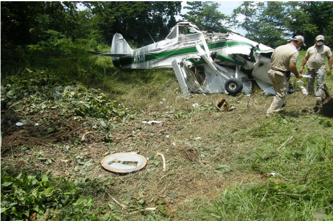
Nótese la deformación de la parte delantera del avión, producto de las gravedades positivas (Gs), absorbidas por la estructura, al impactar con la superficie.
