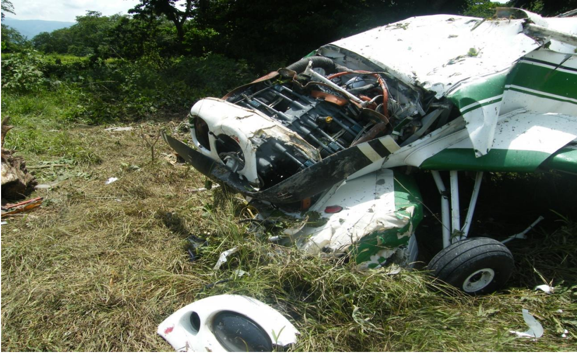
Nótese la deformación sufrida por la hélice, indicando que al momento del impacto el motor estuvo apagado.
