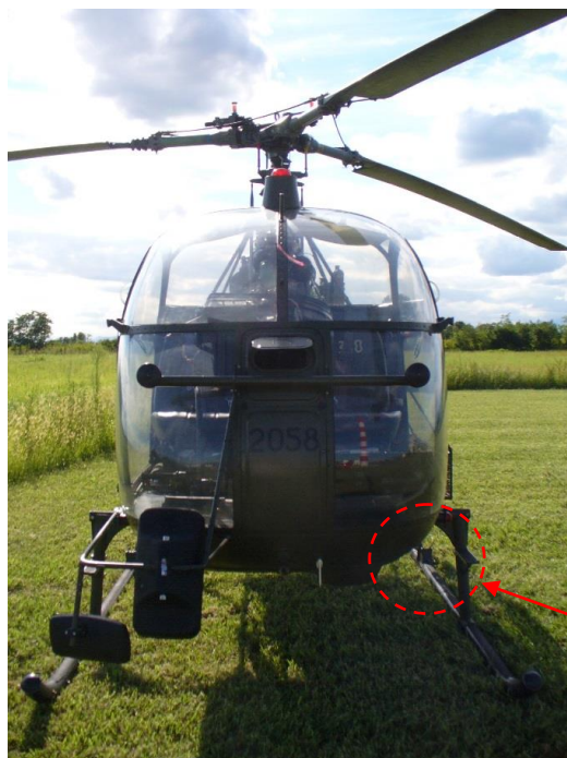
Foto 14-15: nella foto a sinistra, evidenziata, la luce di navigazione sinistra; nella foto a destra, struttura della porta lato sinistro e presenza luce navigazione sinistra, ripresi nel punto di impatto iniziale.
