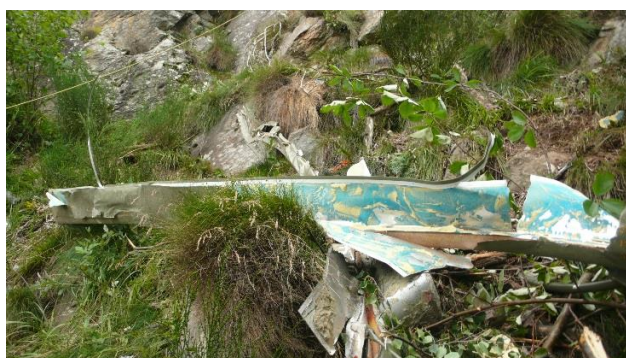
Foto 12: pala rotore principale (notare la rottura).
