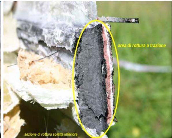
Foto 7: sezione di rottura della soletta inferiore.
