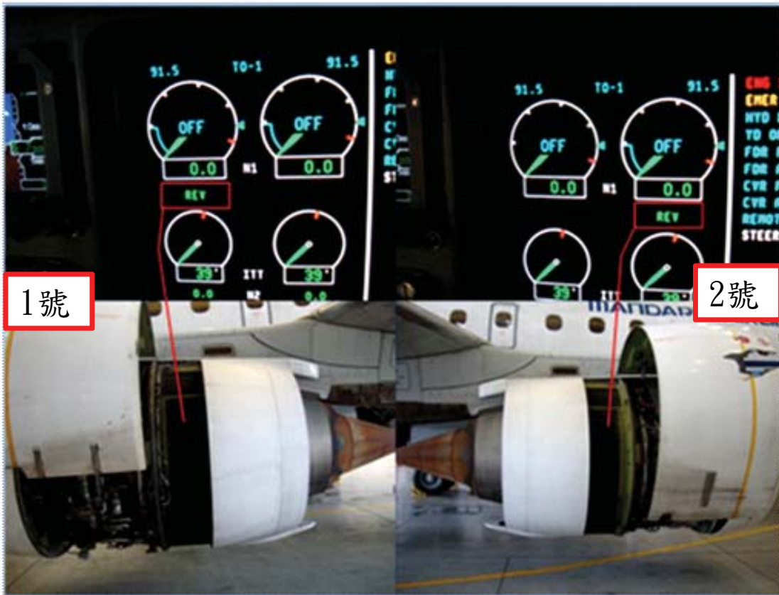
圖 1.16-3 左/右發動機反推力器功能測試
