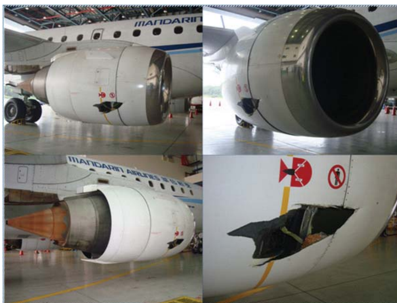
圖 1.12-3 右發動機進氣罩及外側風扇罩一處穿孔
