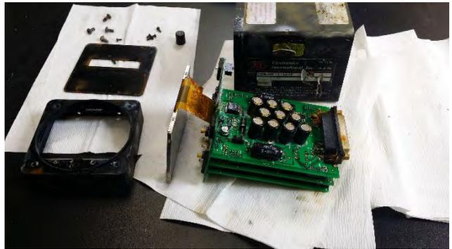
Foto 26: apertura e separazione schede registratore I-LOVI.
