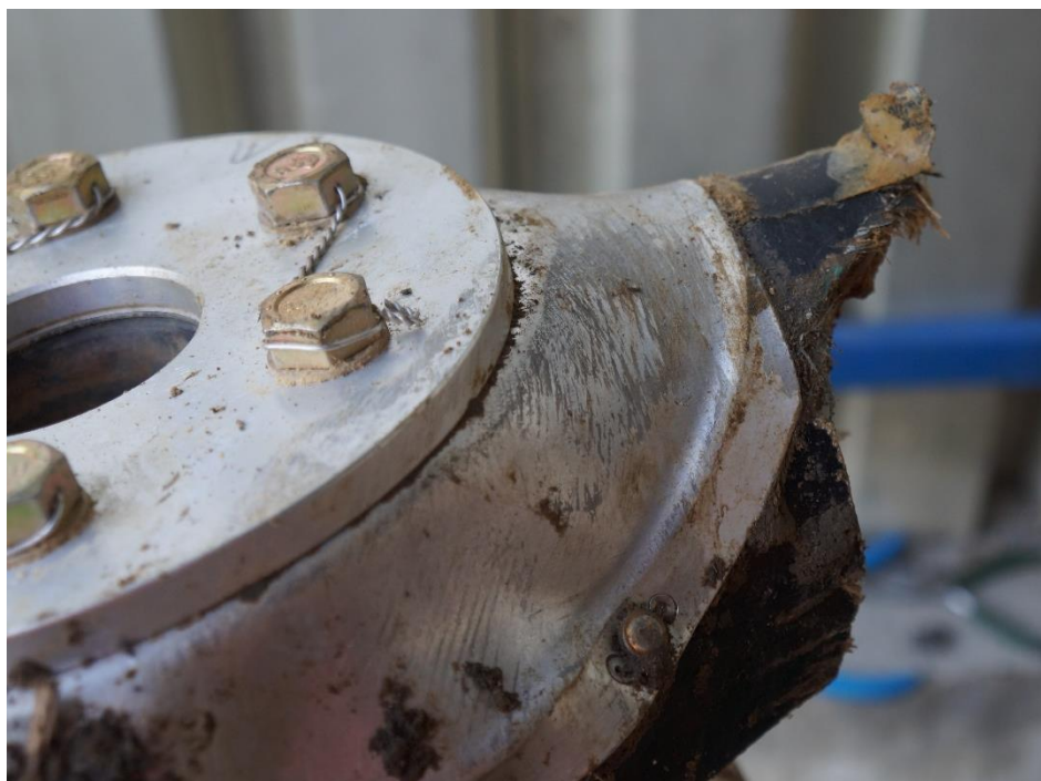
Slika 2.15. Oštećenja na propeleru
