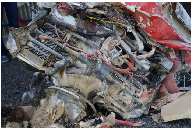
Slika 2.2. Motor i kablovi sustava paljenja
