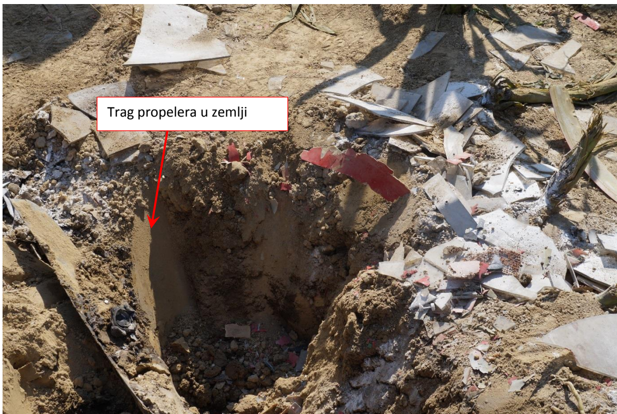
Slika 1.10. Mjesto udara propelera u tlo
