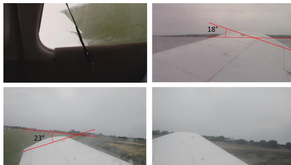
Figur 14. Höger och vänster vinge efter start och före markkontakt. Foto: privat.
