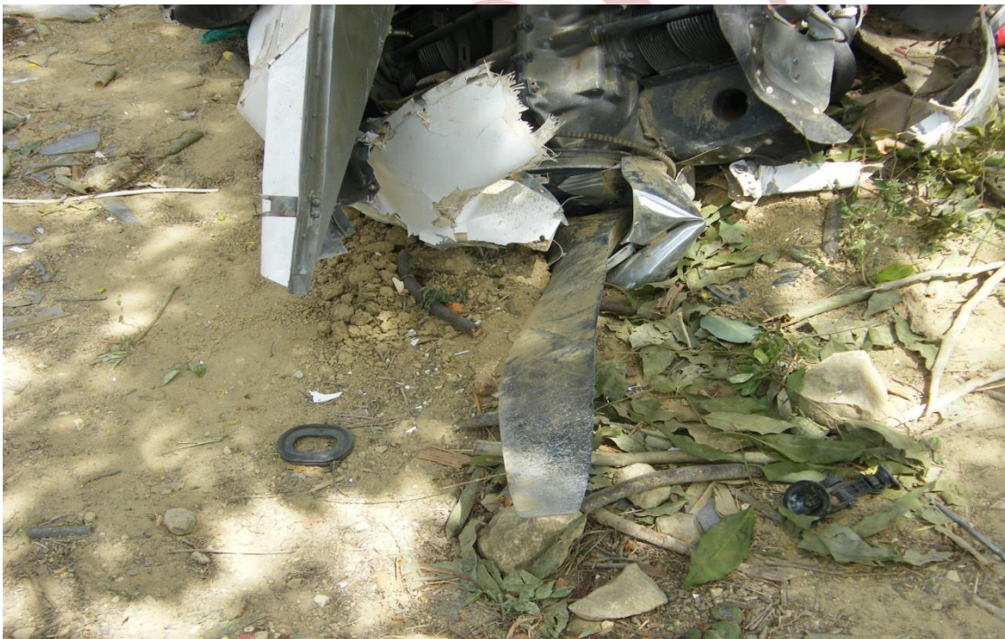
Nótese la condición de la hélice de la aeronave, la cual indica que al momento del impacto, el motor no estuvo produciendo potencia.
