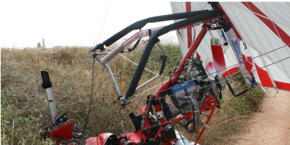
Slika 5 – deformacije trokuta i cijevi konstrukcije zrakoplova
