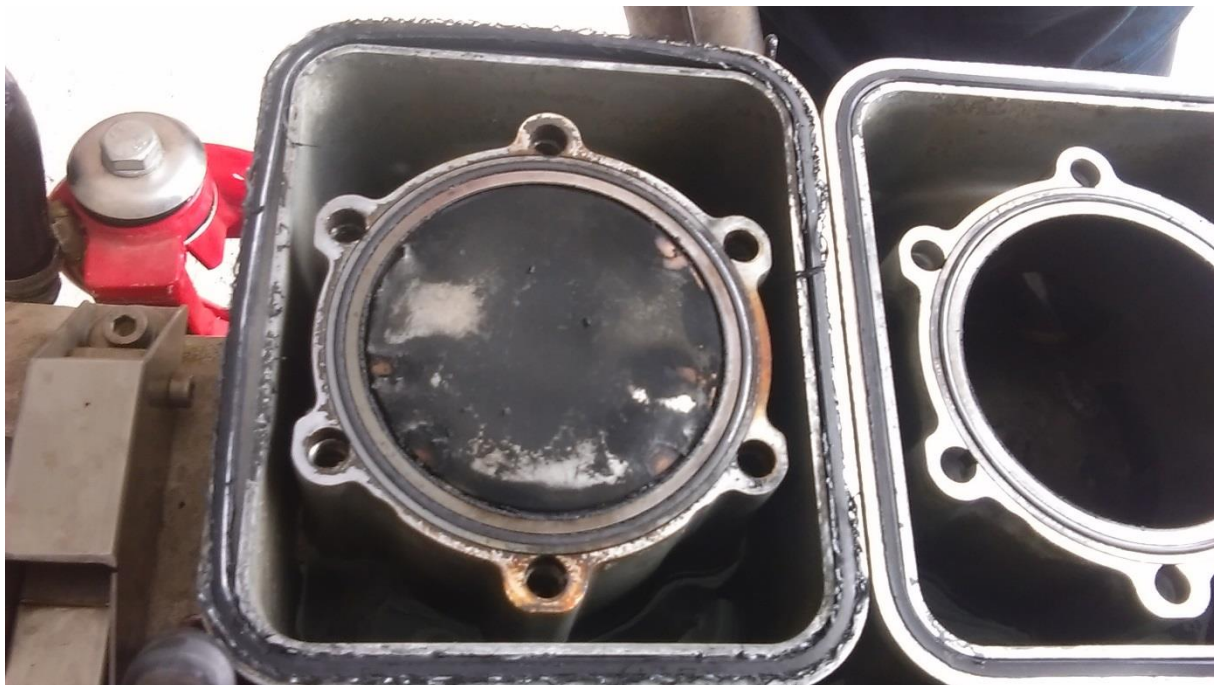
Slika 6 – naslage od izgaranja na čelu klipa. Vidljiva je i znatno oštećena brtva glave cilindra br. 1 (lijevo).
