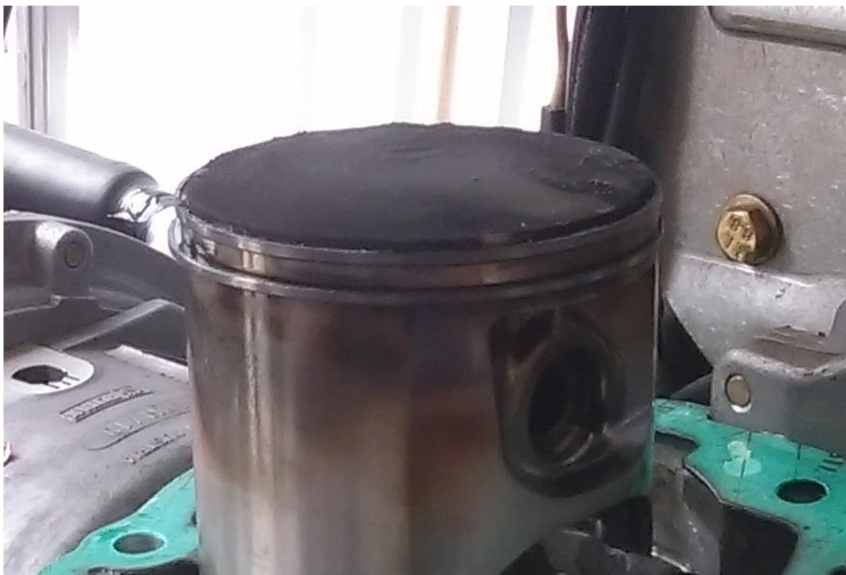
Slika 7 – naslage od izgaranja vidljive na čelu klipa br. 2
