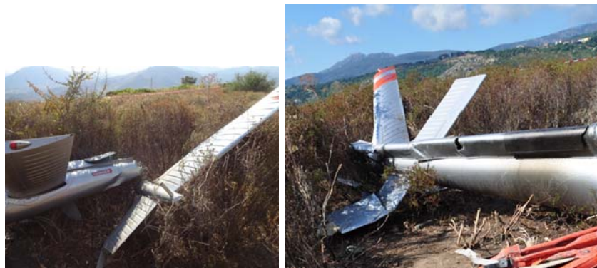
Foto 11 e 12: coda priva del rotore.
