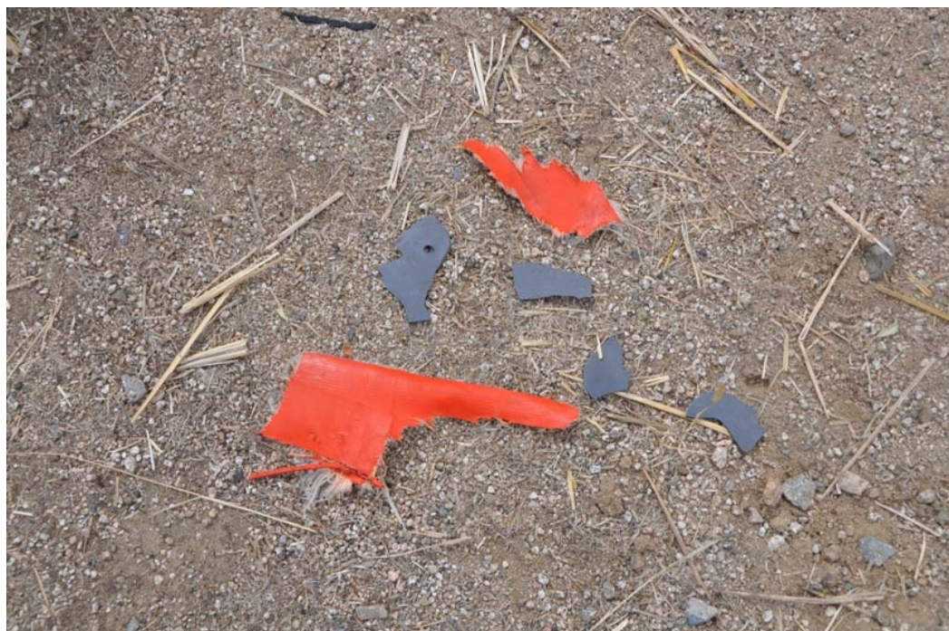
Foto 9: frammenti del Bambi Bucket rinvenuti sul punto di sgancio dell'acqua.
