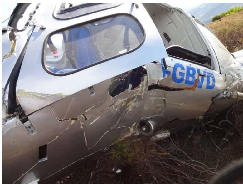
Foto 14: vista della parte inferiore alla cabina.
