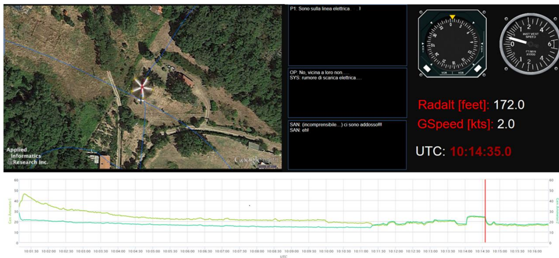
Immagine animazione 5: rumore di scarica elettrica dovuta al corto circuito fra elettrodotto e cavo verricello.
