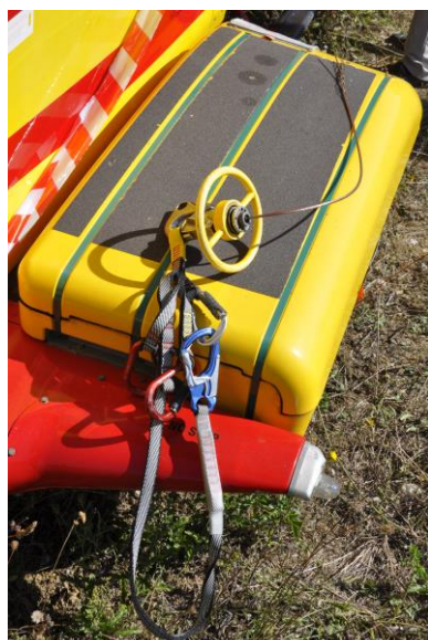
Foto 33: cavo verricello lato gancio con imbracature sanitarie.
