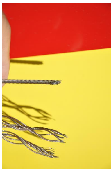
Foto 34: punto di rottura cavo verricello lato gancio.
