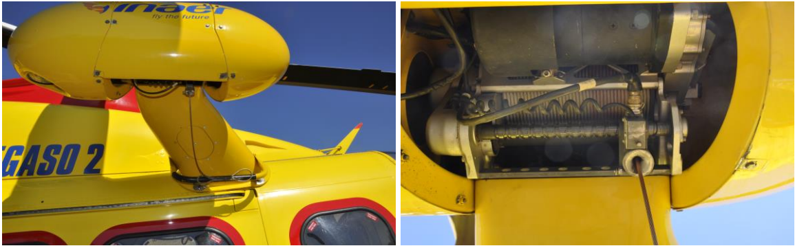
Foto 11 e 12: cavo verricello assicurato alla struttura (a sinistra); sistema tranciamento cavo verricello non attivato (a destra).
