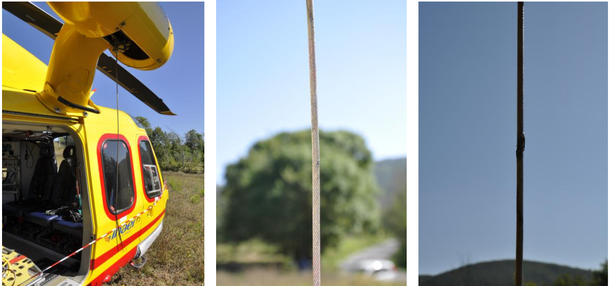
Foto 8, 9 e 10: cavo verricello e punti di sfregamento, sollecitazione termica e parziale rottura.
