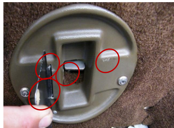
Marcas de impacto producidas por el objeto en el área de la palanca de drenaje.
