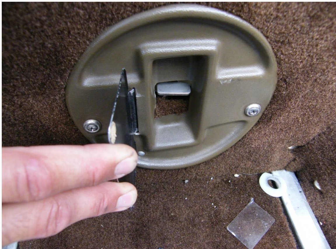
Vista de la tapa y la palanca de drenaje.
