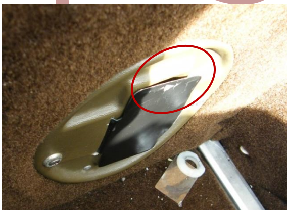
Muestra de deformación en la tapa que cubre la palanca de drenaje.
