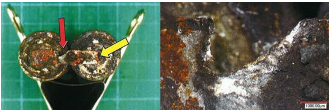
圖 1.16-5 單電池並聯金屬片斷裂（黃箭頭）及疑似電弧發生處（紅箭頭及右圖）
