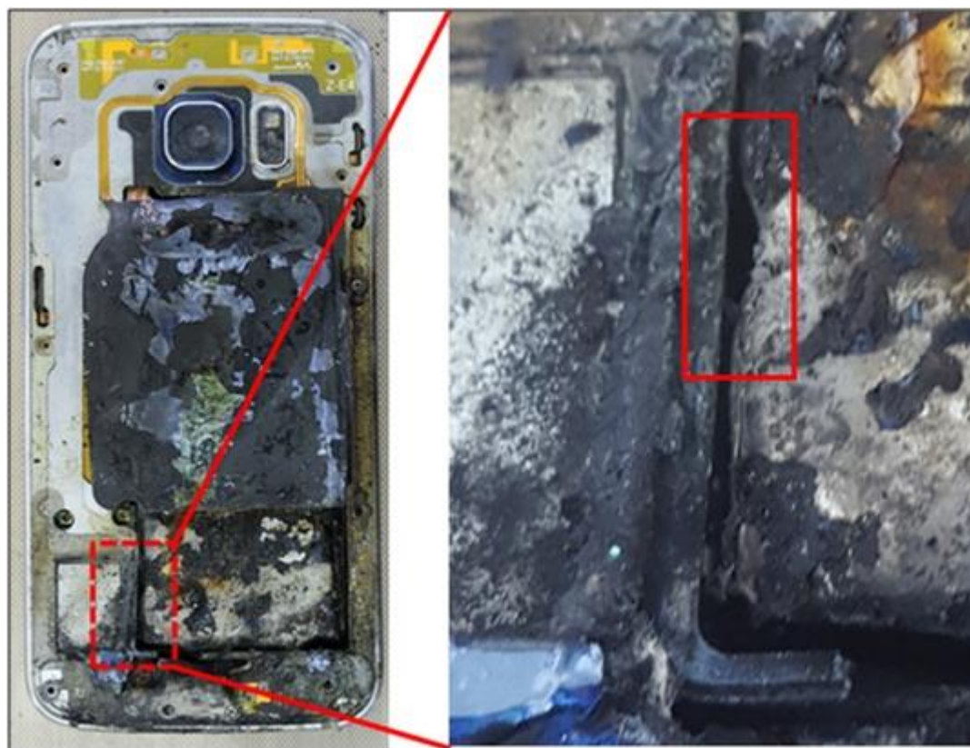
圖 1.18-1 電池左下角外觀疑似變形位置
