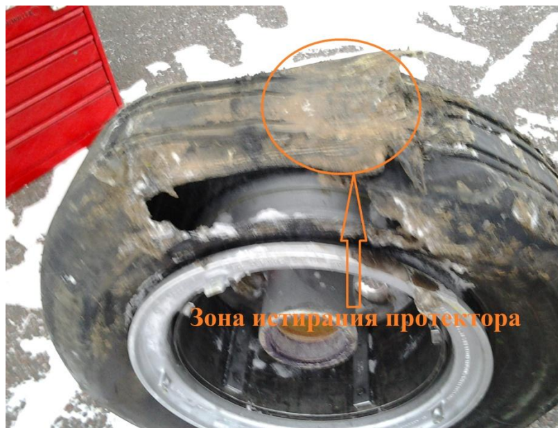
Фото 2. Разрушение пневматика колеса левой опоры шасси
