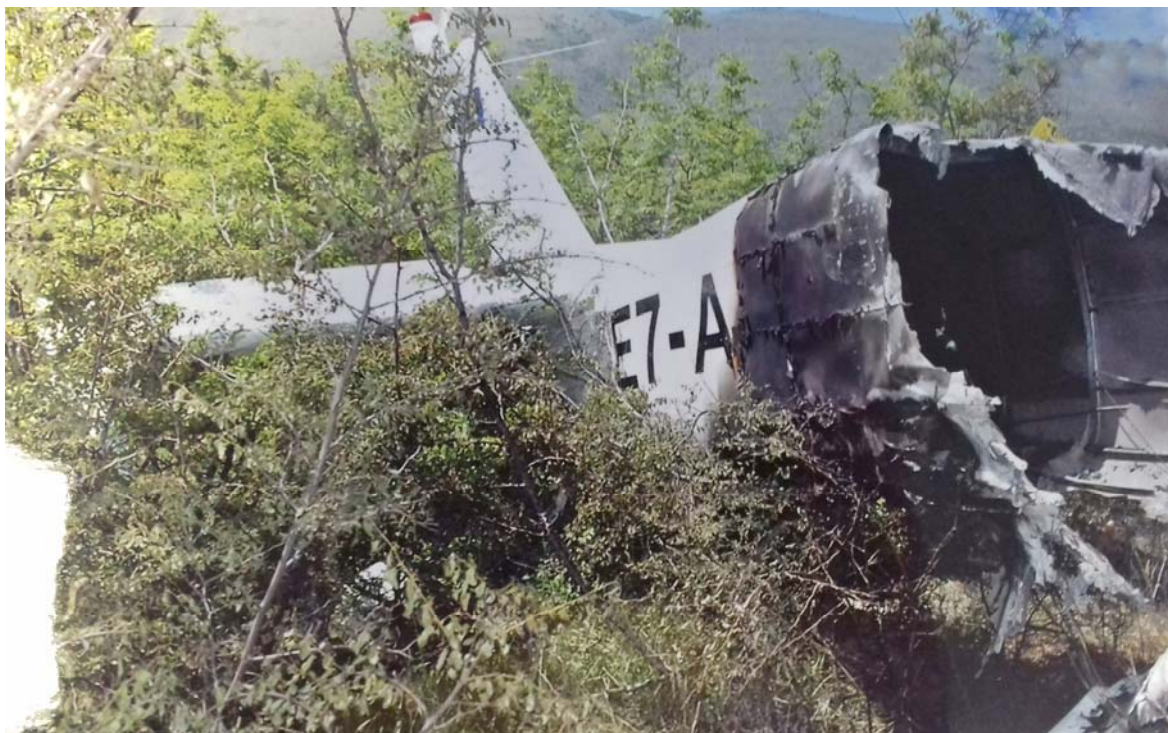
Slika broj 13. 11: Zadnji dio trupa i repne površine (Trag 20)
