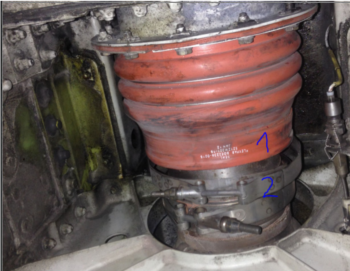
Bulk Seal mit gelöster Schelle (Loose Clamp)
