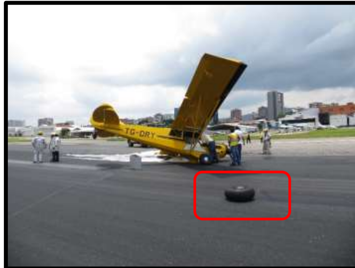
Fotografía No.: 7 Vista de la rueda, la cual se fracturo de su base.
