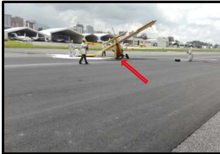
Fotografía No.: 3 Vista de los daños del tren de aterrizaje.
