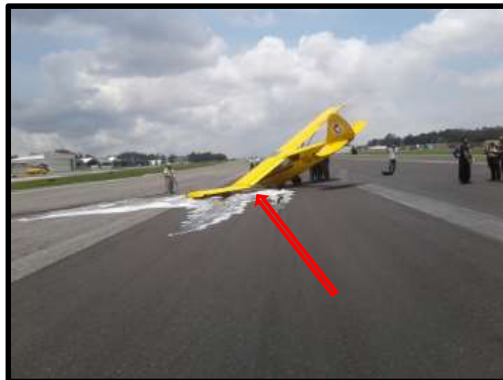
Fotografía No.: 4 Daño al medio y extremo del ala izquierda.
