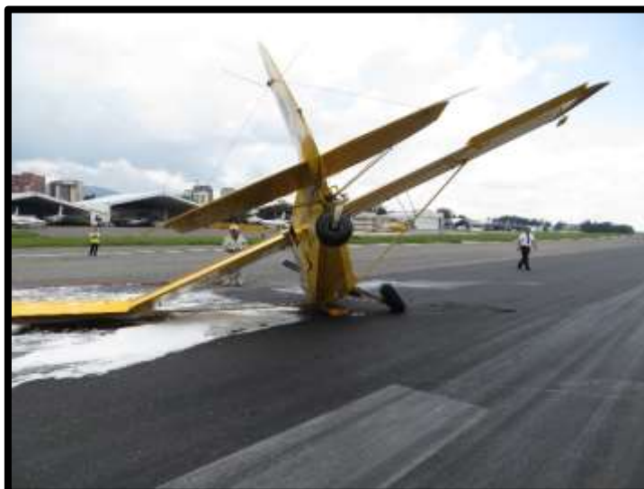
Fotografía No.: 9 Vista del daño en el tren de aterrizaje, vista posterior.
