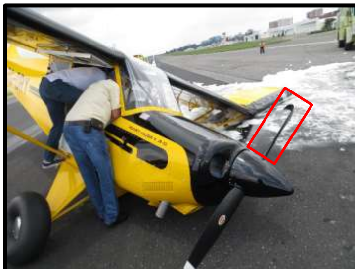
Fotografía No.: 6 Vista del daño a una de las aspas de la hélice.
