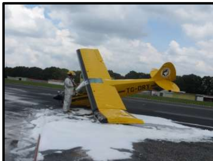
Fotografía No.: 8 Vista cercana del daño en ala izquierda.
