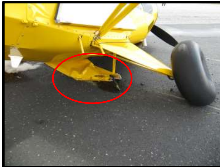
Fotografía No.: 5 Vista posterior de daños en el tren principal izquierdo.
