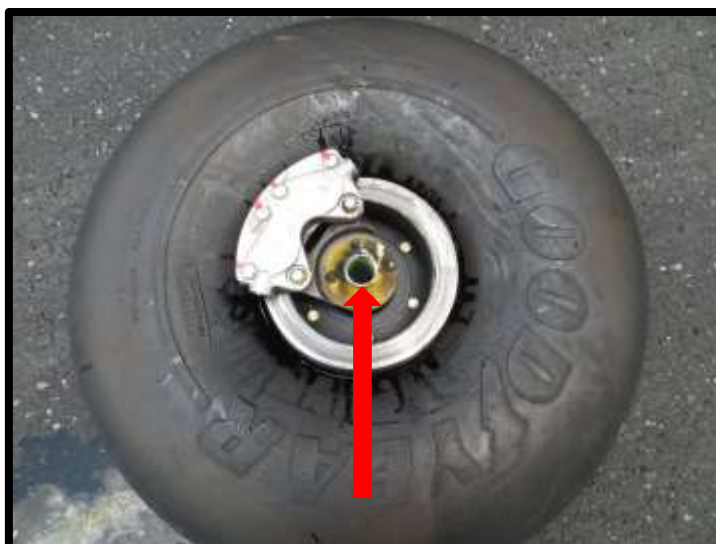
Fotografía No.: 10 Vista del eje que soporta la rueda principal izquierda fracturada.
