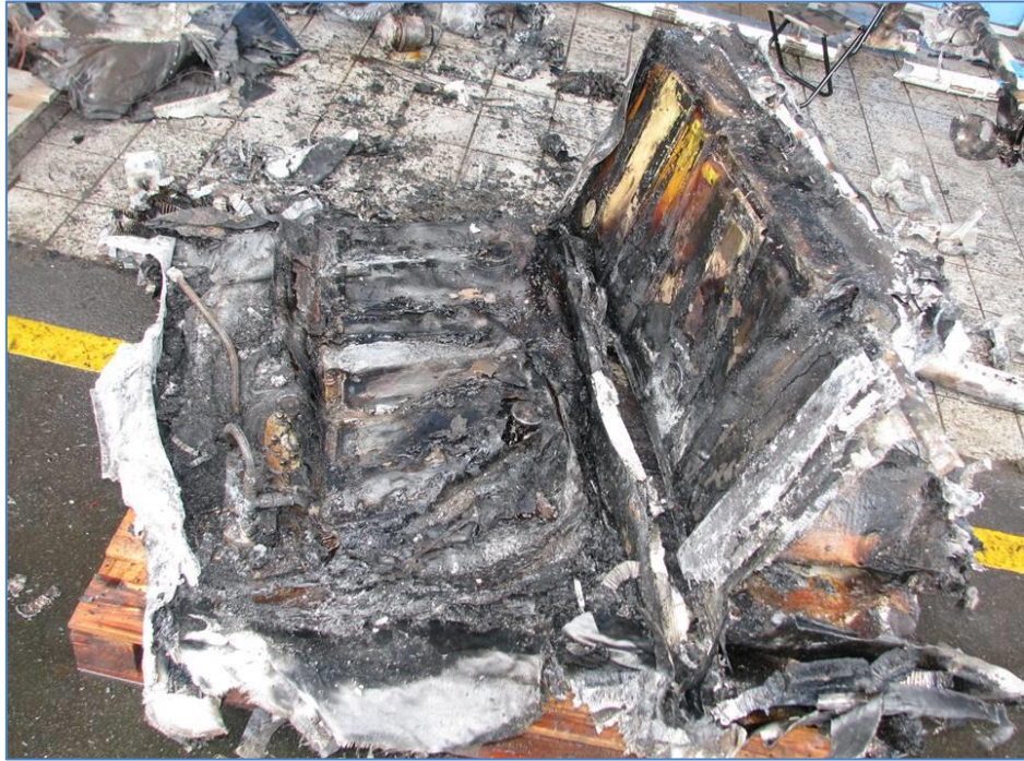
圖 1.16-6 L 型油箱燒毀情形
