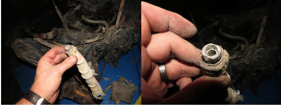
圖 1.12-12 燃油管接頭斷落情形
