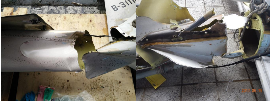
圖 1.16-1 尾桁蒙皮因破損嚴重且變形曲面呈直線狀
