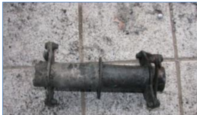
圖 1.16-10 撓性主傳動軸彎曲斷裂面皆呈現過負載破壞現象
