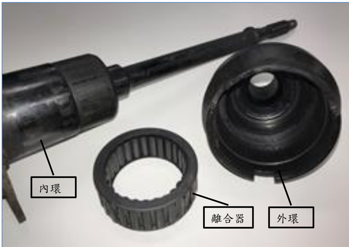
圖 1.16-11 自由飛輪無異常磨耗痕跡
