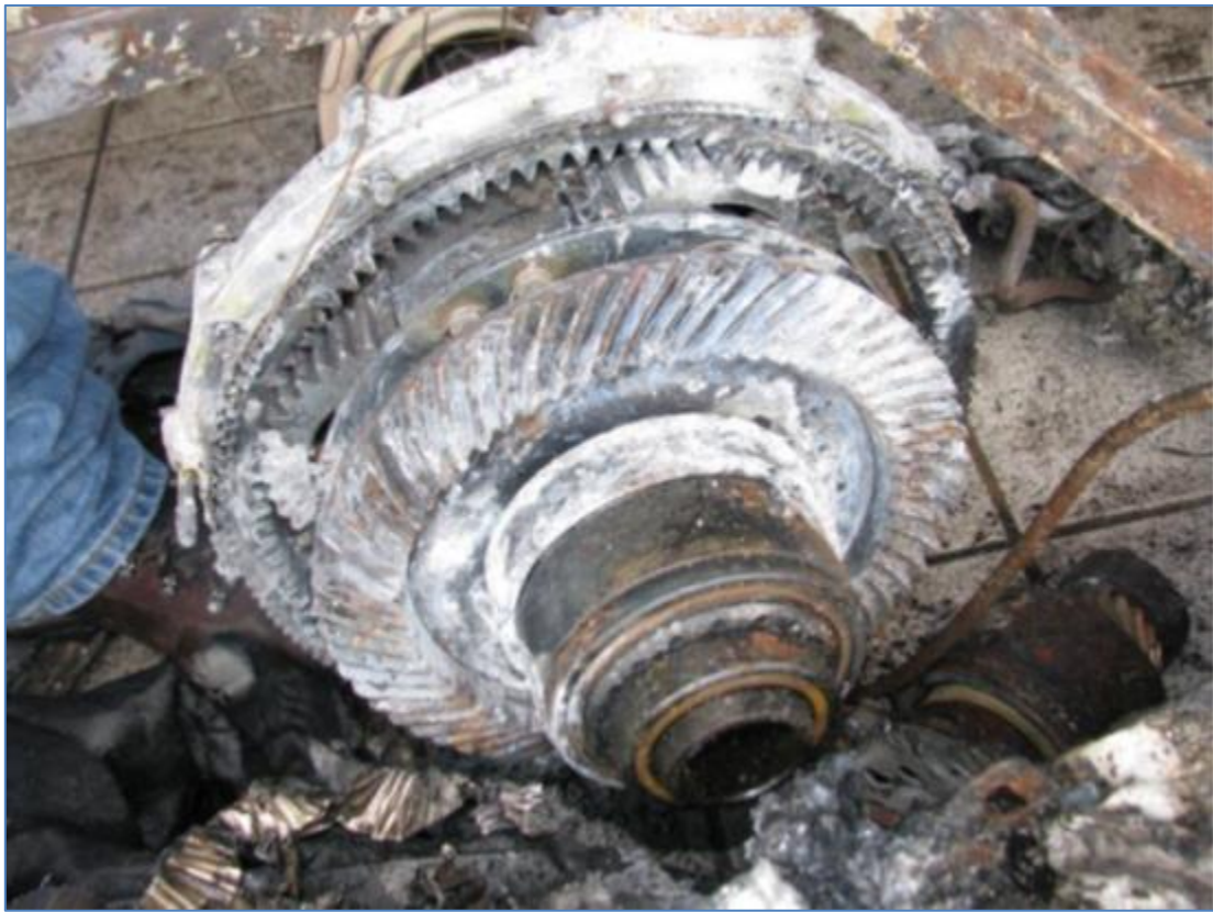
圖 1.16-9 主齒輪箱損壞情形
