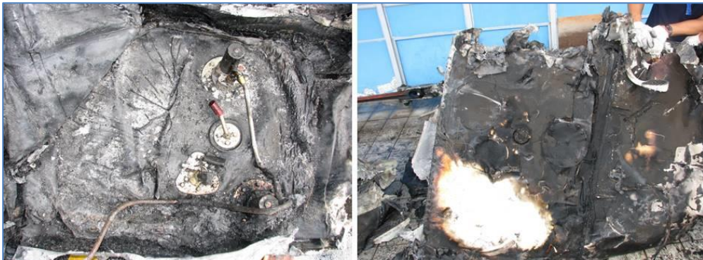
圖 1.16-7 油箱底部內外部燒毀狀況
