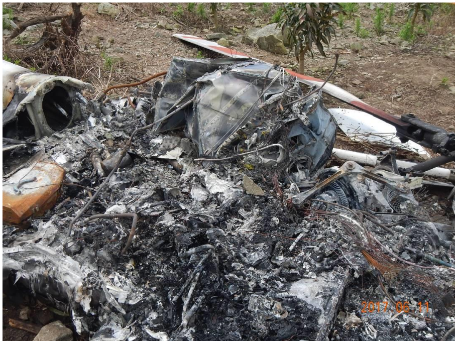
圖 1.12-7 機身結構及蒙皮完全焚毀情形
