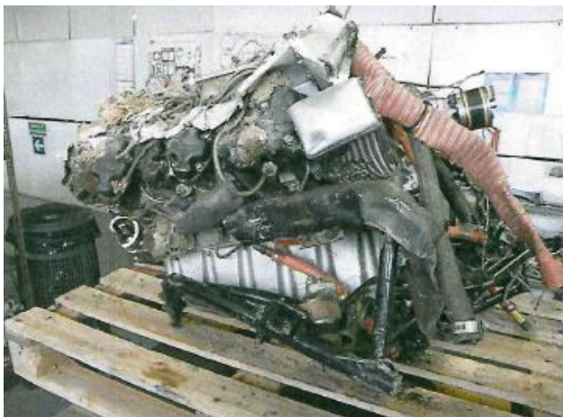
Foto 16 e 17: motore destro dell'aeromobile e piastra di attacco del turbocompressore.
