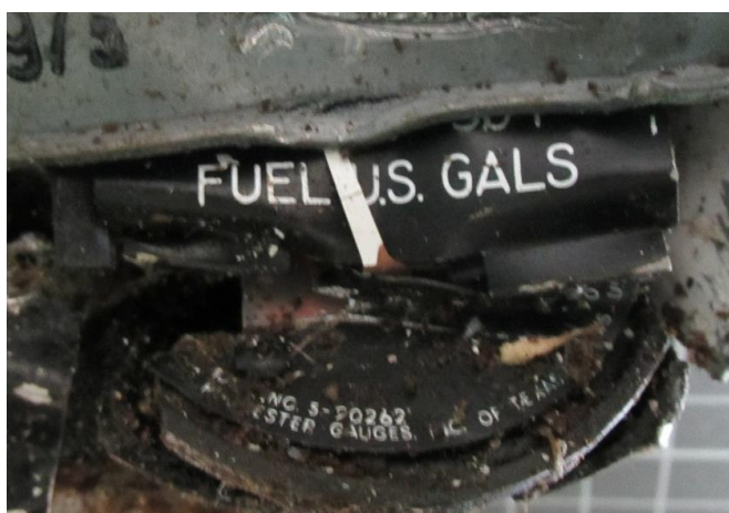
Foto 13 e 14: indicatori quantità carburante ed amperaggio.
