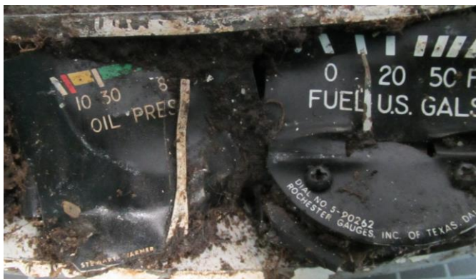
Foto 11 e 12: indicatori oil press , quantità carburante e temperatura testate cilindri.
