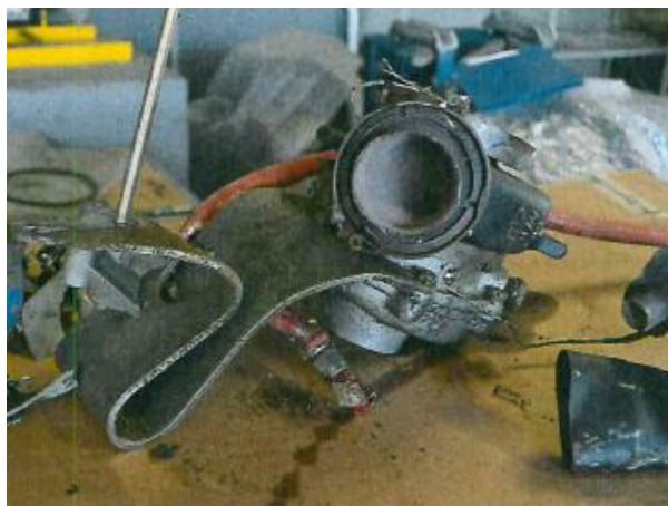
Foto 16 e 17: motore destro dell'aeromobile e piastra di attacco del turbocompressore.
