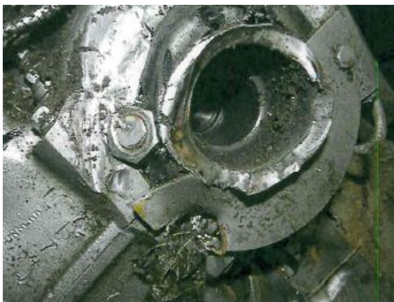
Foto 18 e 19: dado di attacco del compressivo elica e rilevamenti sul mozzo.
