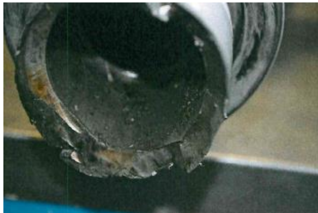
Foto 18 e 19: dado di attacco del compressivo elica e rilevamenti sul mozzo.
