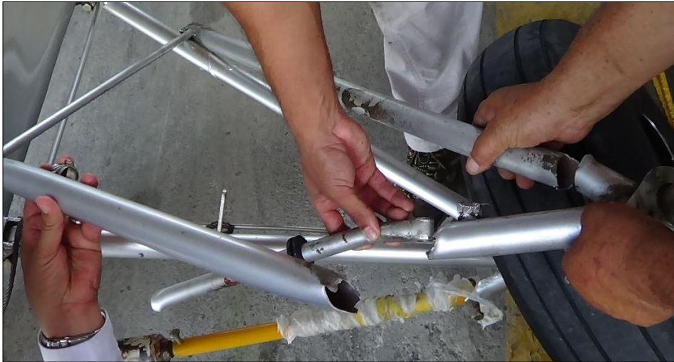
Fotografía No. 6: Evidencias fractura y daño estructural tren principal izquierdo
