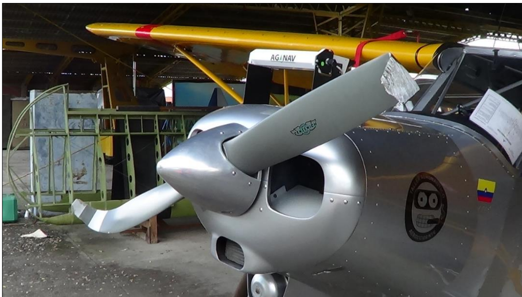
Fotografía No. 5: Daño hélice HK-630 G, marcas de alta potencia al momento del impacto
