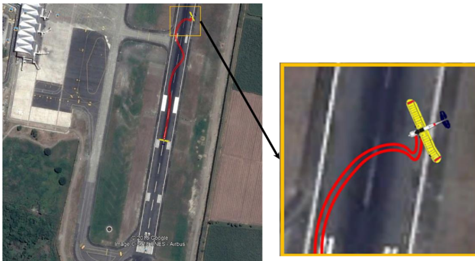
Gráfico No. 5: Secuencia de eventos, trayectoria descrita por la aeronave posteriormente al aterrizaje, durante su desaceleración en la pista
