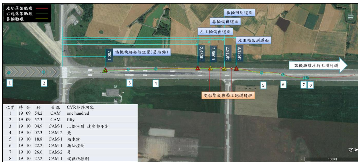
圖 1.12-4 現場量測、機場空照圖與部分 CVR 抄件套疊圖
