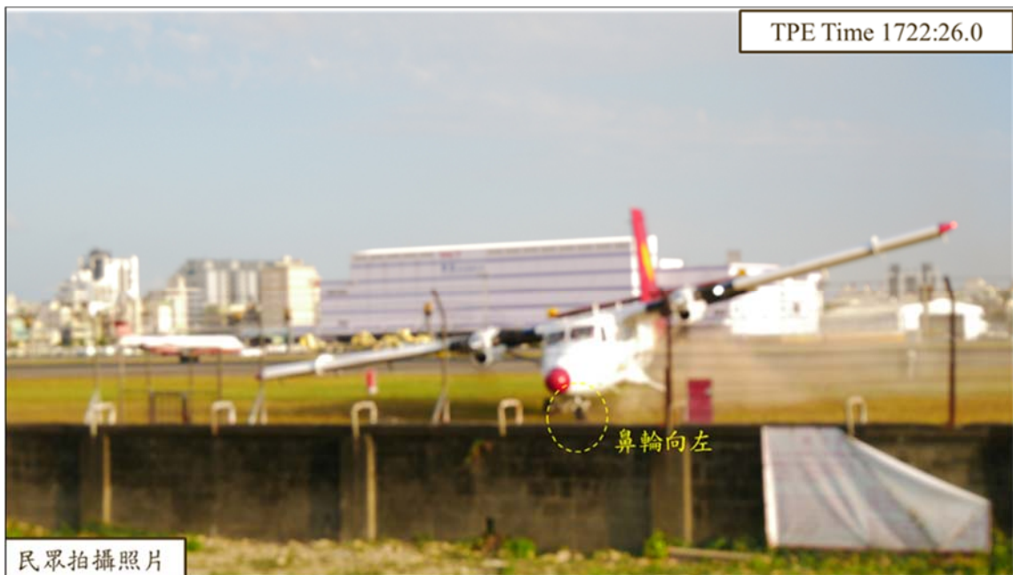
圖 1.11-13 事故機航向與跑道方向垂直照片
