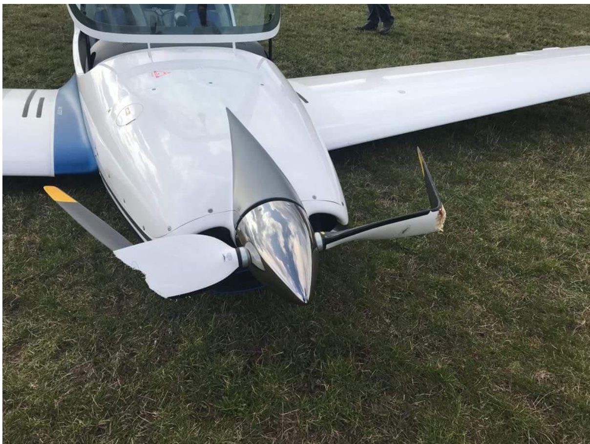
Rys. 6. Widok uszkodzonych łopat samolotu po lądowaniu bez wypuszczonego podwozia [źródło: właściciel SP].
