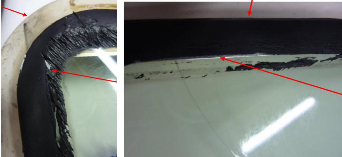
图 110 风挡 (PN STA320-2-7-1A SN 5906) 气象封严
