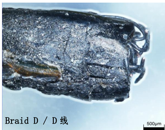
图 45 D 线电镜检查 (参见附录 1_Ref.1)
