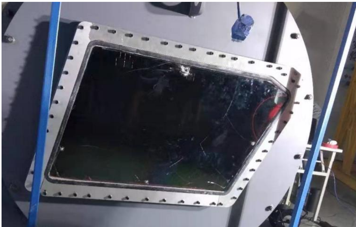
图 92 风挡试验件的安装状态(参见附录 1_Ref.8)
