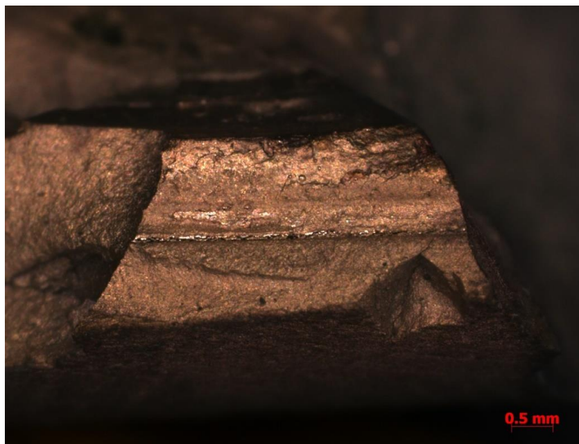
图 61 橡胶断口表面槽痕痕迹的宏观形貌（参见附录 1_Ref.4）
