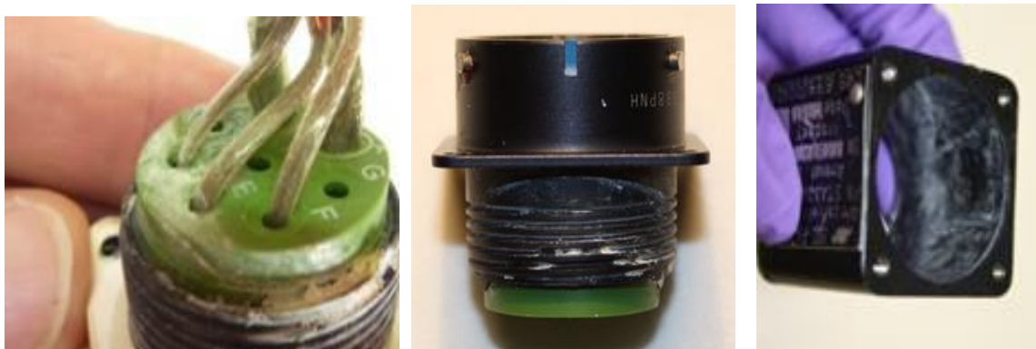
图 49 B-6419 号机的接线盒分解后的内部（参见附录 1_Ref.17）
