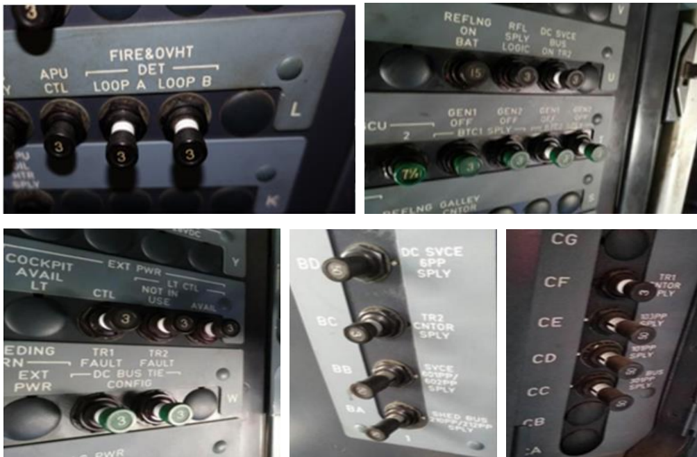
图 27 120VU 上弹出的 17 个电路跳开关
