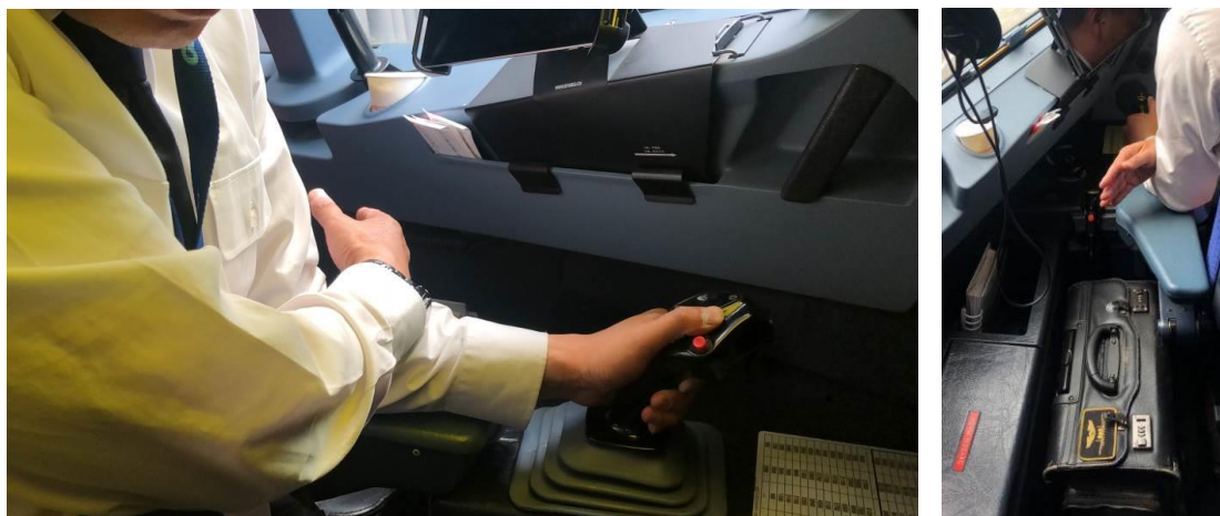
图 121 机长位系紧肩带操纵侧杆时取用氧气面罩示意图
