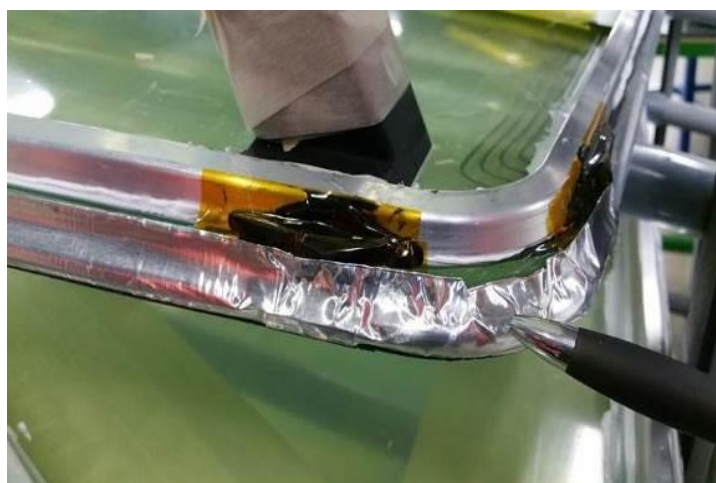
图 103 风挡边缘铝胶带褶皱 (A330 飞机上的同型风挡)
