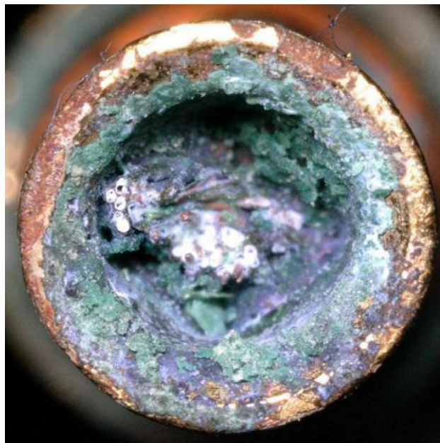
图 52 C 钉接线端内部残存的腐蚀导线 (BEA 实验室)
