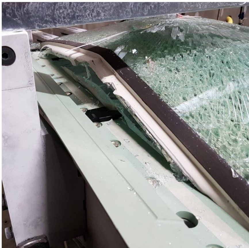
图 98 三层玻璃碎裂后风挡边缘从安装框脱出 (参见附录 1_Ref.9)
