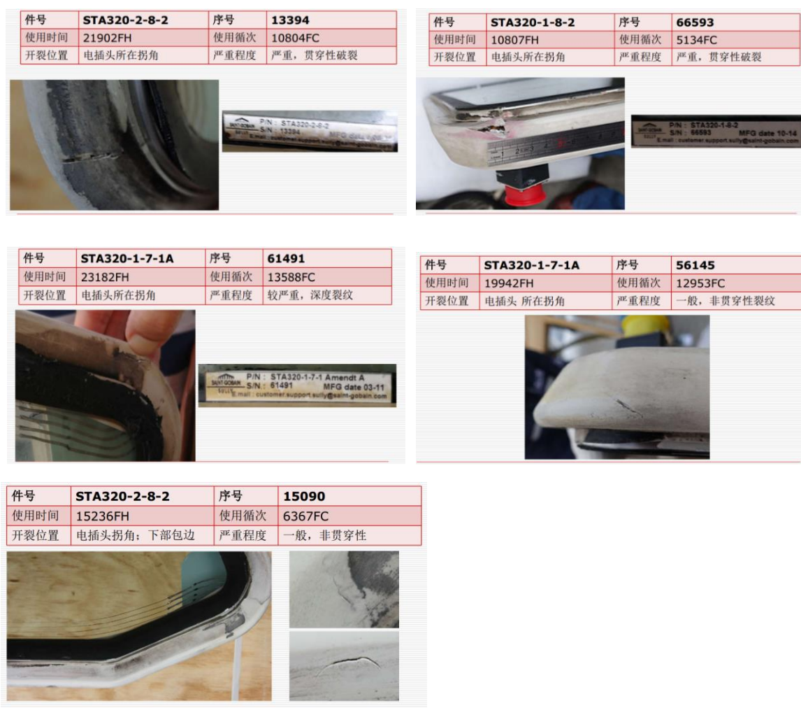
图 104 封严硅胶损伤的风挡信息
