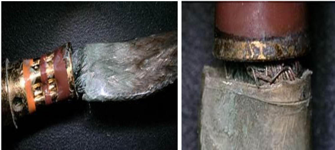
图 35 接线盒中插钉内侧绝缘皮的套合区域部分金属裸露
