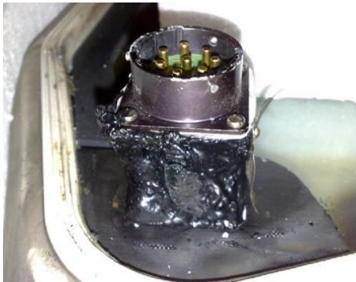
图 109 2010 年 11 月 15 日 B-6608 号机风挡玻璃接线块高温鼓包
