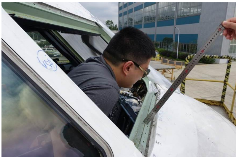
图 123 事发时副驾驶探出风挡的可能位置示意图
