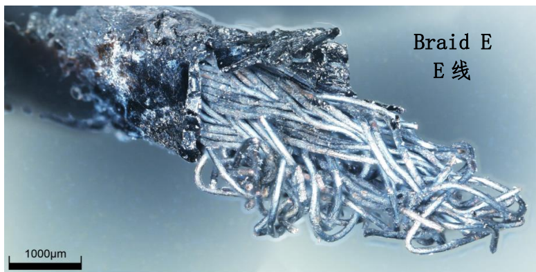
图 46 E 线电镜检查 (参见附录 1_Ref.1)
