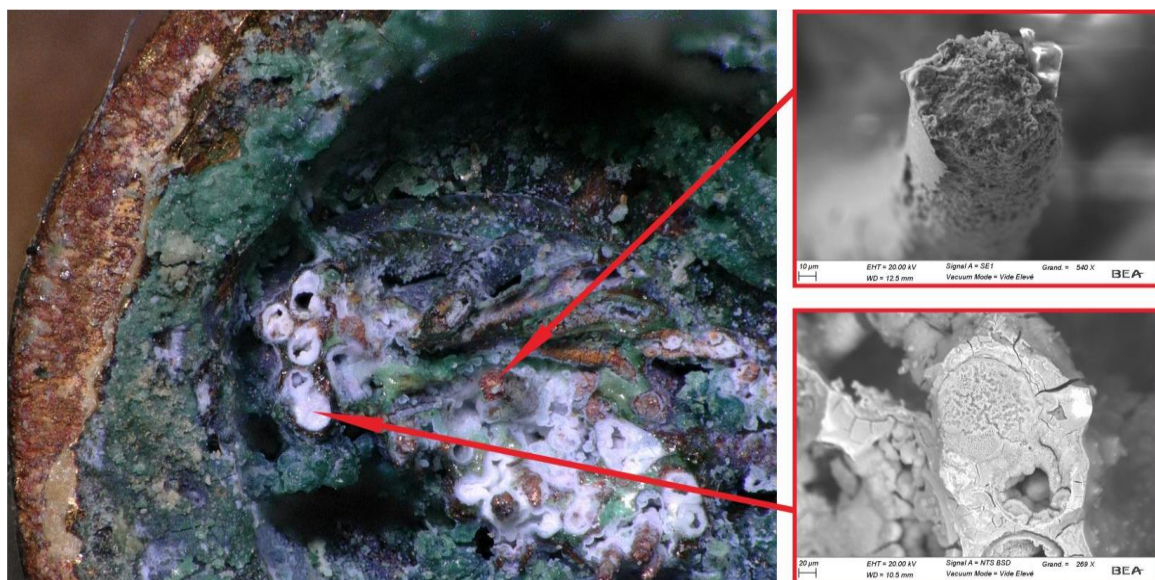
图 53 C 钉接线端内部的宏观和微观形貌 (BEA 实验室)
