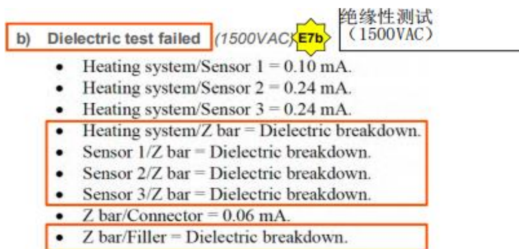
图 106 SGS 对风挡（PN:STA320-2-7-1A SN:7014）电加温插头进行绝缘测试
