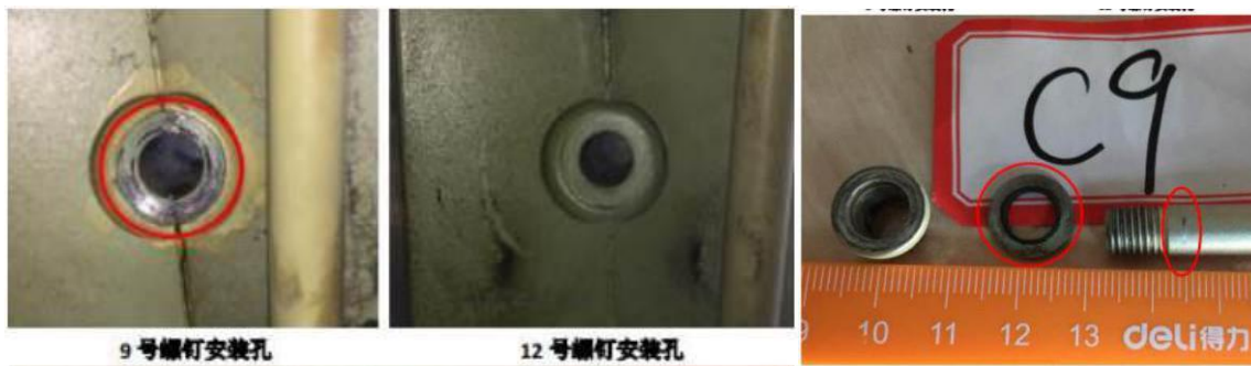
图 26 9号紧固件磨损痕迹
