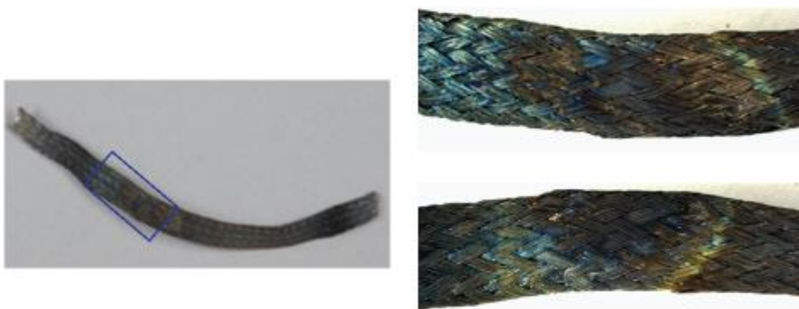
图 74 不带绝缘皮导线的变色情况（参见附录 1_Ref.6）
