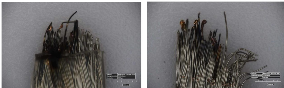
图 64 干燥环境起弧后加温导线端头的宏观形貌（参见附录 1_Ref.11）
