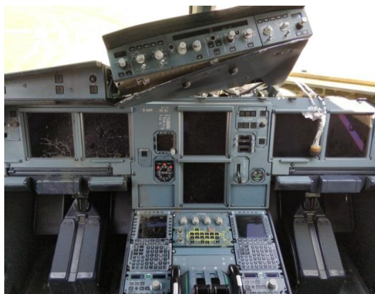
图 16 驾驶舱 FCU 翘起，130VU 缺失
