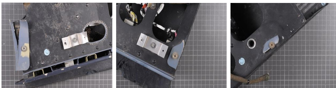
图 88 1-3 号连接位置的宏观形貌
