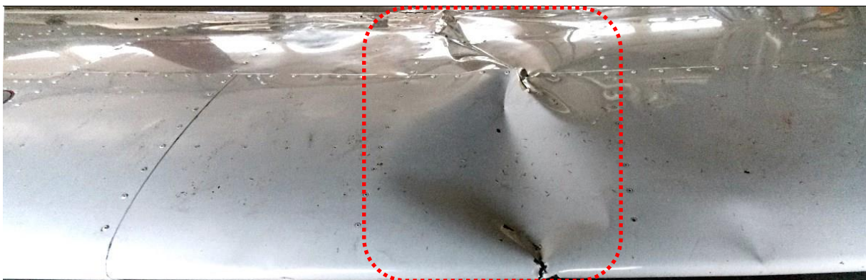
Rys.12 – Uszkodzone lewe skrzydło samolotu – widok od strony noska [foto: PKBWL].
