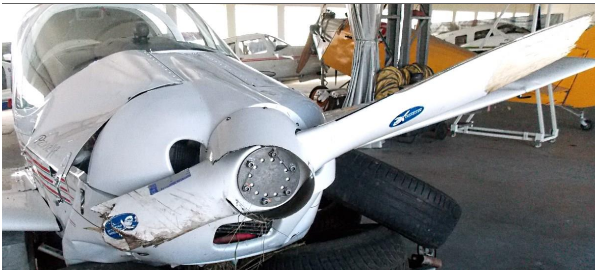
Rys.14 – Uszkodzone osłony silnika, zniszczone śmigło i jego kołpak [foto: PKBWL].
