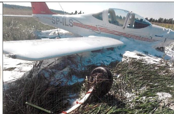
Rys. 6 – Samolot na miejscu wypadku. Na pierwszym planie widoczne oderwane prawe podwozie główne [foto: Silvair sp. z o.o.].
