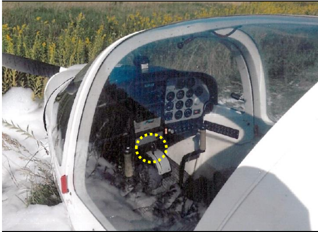
Rys.17 – Widok na wnętrze kabiny na miejscu wypadku [foto: Silvair sp. z o.o.] Zaznaczona dźwignia przepustnicy
