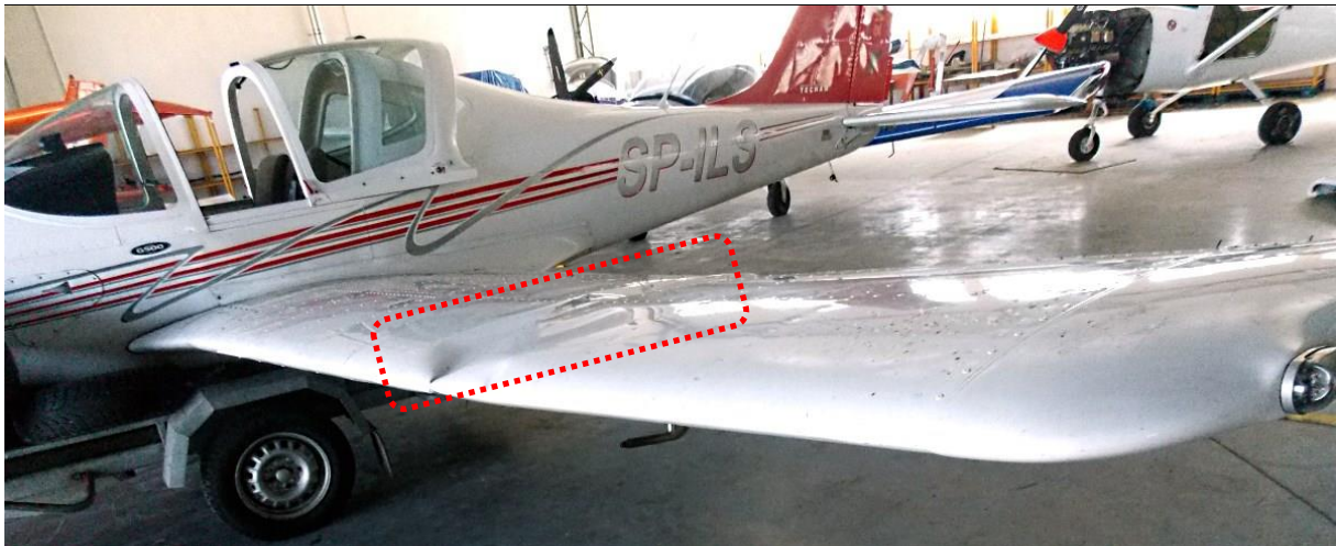
Rys.10 – Uszkodzone lewe skrzydło [foto: PKBWL].
