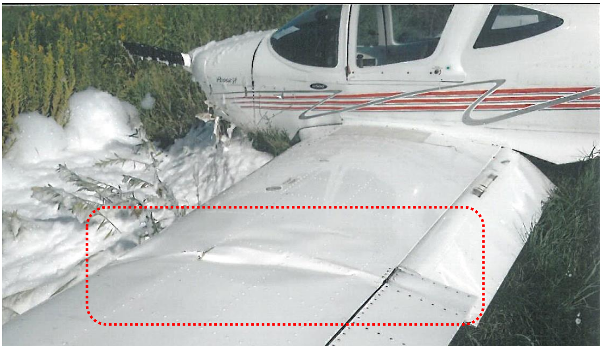
Rys.11 – Uszkodzone lewe skrzydło samolotu [foto: Silvair sp. z o.o.].
