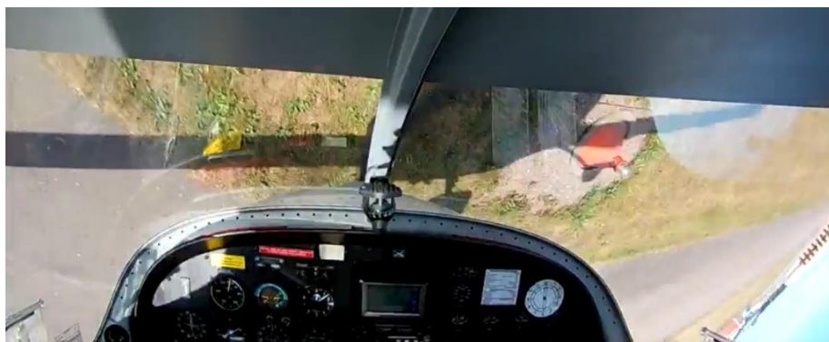
Figur 11: Flygplanet upp och ner. Propellern träffar marken (notera skuggan där landställen och vingar verkar oskadade). Källa: Pilotens GoPro-kamera.
