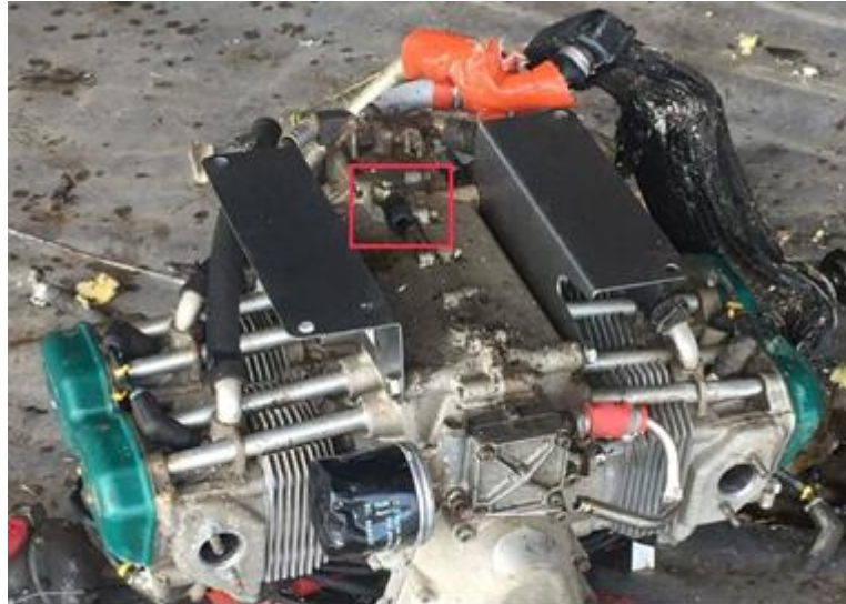
Foto 25: per poter separare il motore, la tubazione collegata al basamento del motore è stata tagliata. Sull'attacco del basamento è rimasto collegato il terminale metallico di collegamento e una piccola porzione di tubazione (riquadro rosso).
