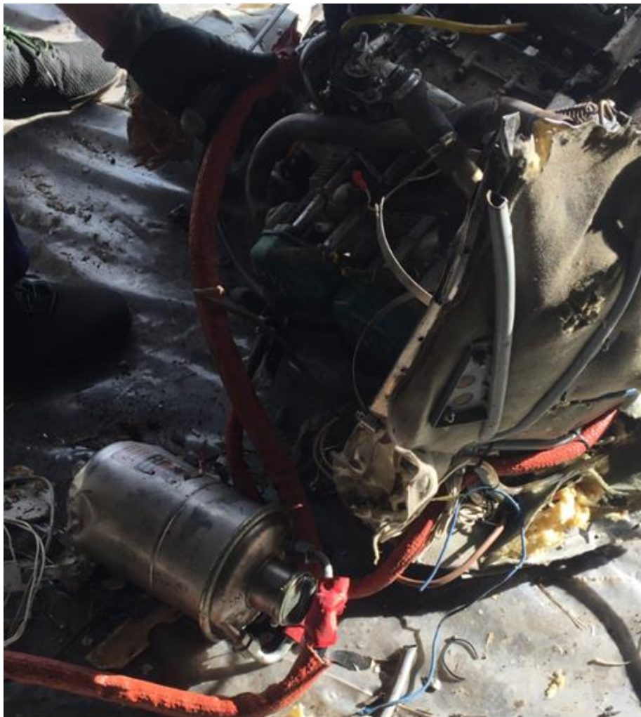
Foto 26: per poter separare il motore la tubazione collegata al radiatore è stata scollegata svitando il bullone di fissaggio.
