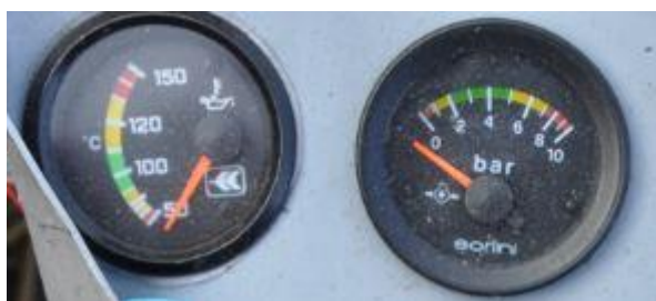
Foto 4: indicatori di temperatura (a sinistra) e pressione olio motore (a destra) del velivolo I-6430.
