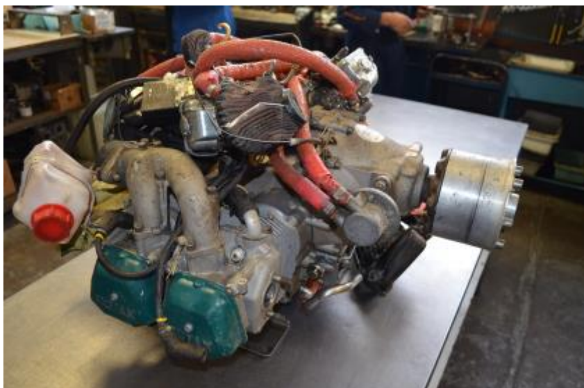
Foto 11: il motore separato dal relitto in procinto di essere smontato per l'investigazione interna.
