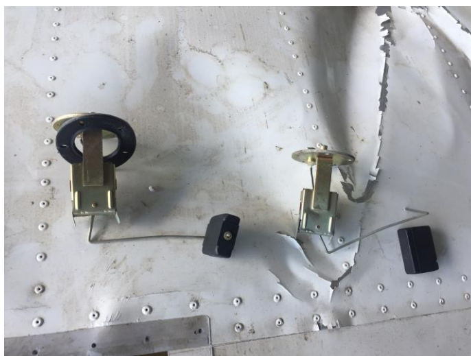
Foto 2: sistema per l'indicazione del livello carburante. Particolare del sensore destro non operativo rinvenuto con galleggiante separato.
