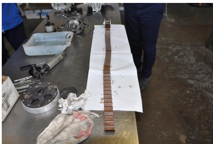
Foto 13: filtro dell'olio dopo l'apertura.
