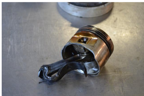
Foto 16 e 17: stato della biella anteriore destra.
