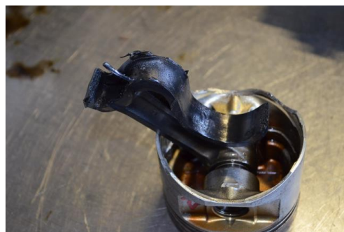
Foto 16 e 17: stato della biella anteriore destra.
