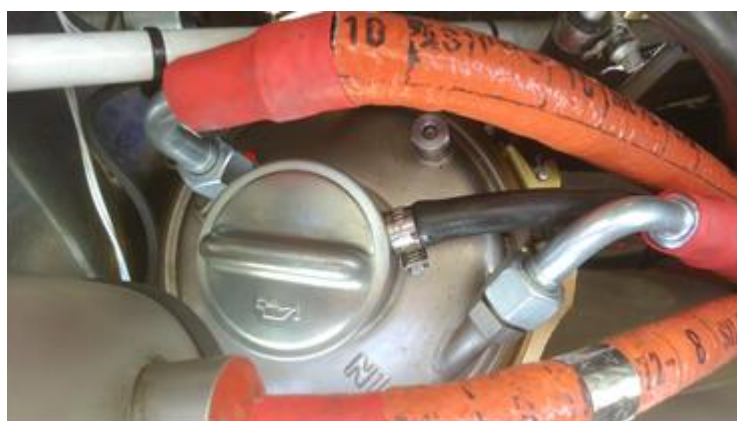
Foto 3: l'innesto "OUT" si presenta pressoché verticale, mentre l'innesto "IN" è inclinato.
