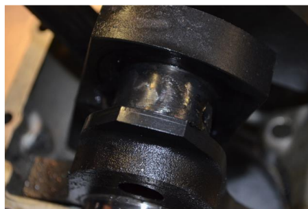
Foto 18 e 19: stato dell'albero motore e del perno dell'albero corrispondente alla biella n. 1.
