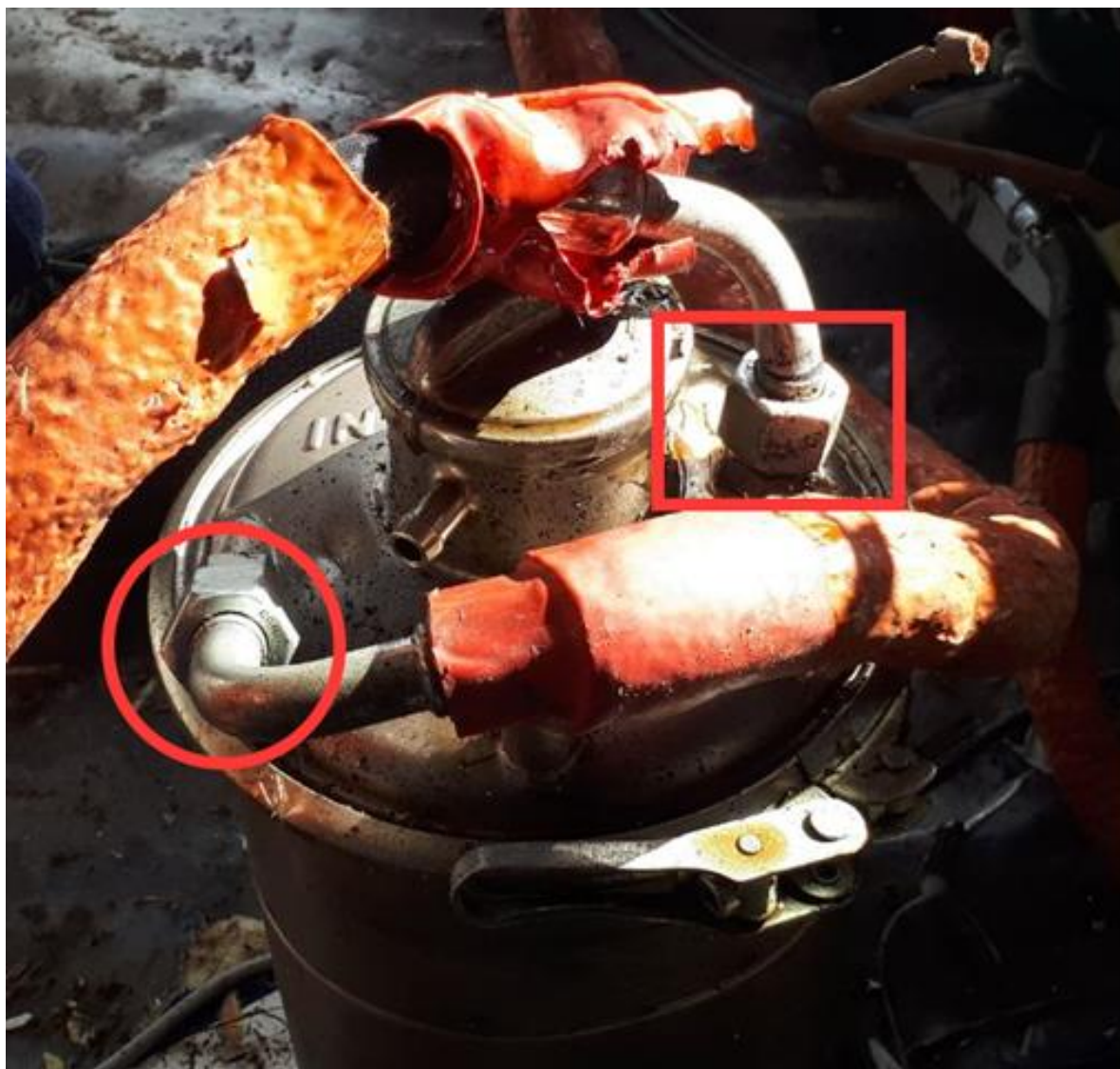
Foto 23: evidenziato con il cerchio rosso (sinistra) l'attacco previsto per la tubazione di ritorno dal basamento motore (con indicazione "IN", inclinato e non dotato di cannula di pescaggio). Evidenziato con il rettangolo rosso (destra) l'attacco previsto per la tubazione di mandata al motore attraverso il radiatore e la pompa (con indicazione "OUT", pressoché verticale a cui corrisponde la cannula di pescaggio).
