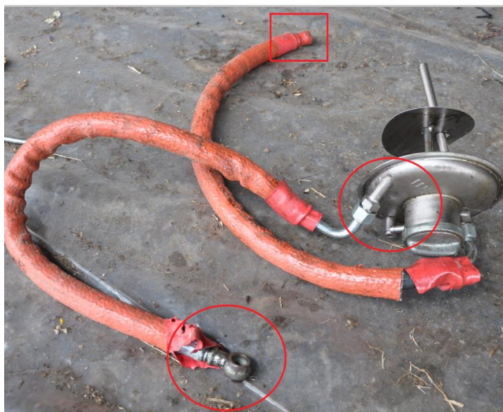
Foto 28: il coperchio del serbatoio, con le tubazioni collegate. Indicata dal cerchio rosso in basso l'estremità ( hose nipple ) separata dal radiatore. L'altra estremità del tubo previsto di mandata dell'olio al motore, indicata dal cerchio rosso a destra, era impropriamente collegata all'attacco "IN" del coperchio del serbatoio, ovvero al punto di attacco previsto per la linea di ritorno dell'olio dal motore. Indicata dal rettangolo rosso in alto la tubazione tagliata in prossimità dell'estremità per la separazione, mancante del terminale metallico ( hose nipple ) e di una porzione di tubo, rimasti vincolati al basamento del motore. Detta tubazione risulta collegata al foro "OUT" del coperchio del serbatoio, cui corrisponde la cannula e che è il punto previsto per la mandata dell'olio dal serbatoio al motore attraverso radiatore e pompa.
