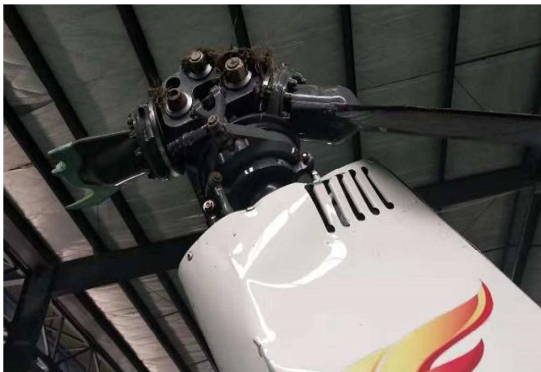
图 7 主桨毂损坏图
