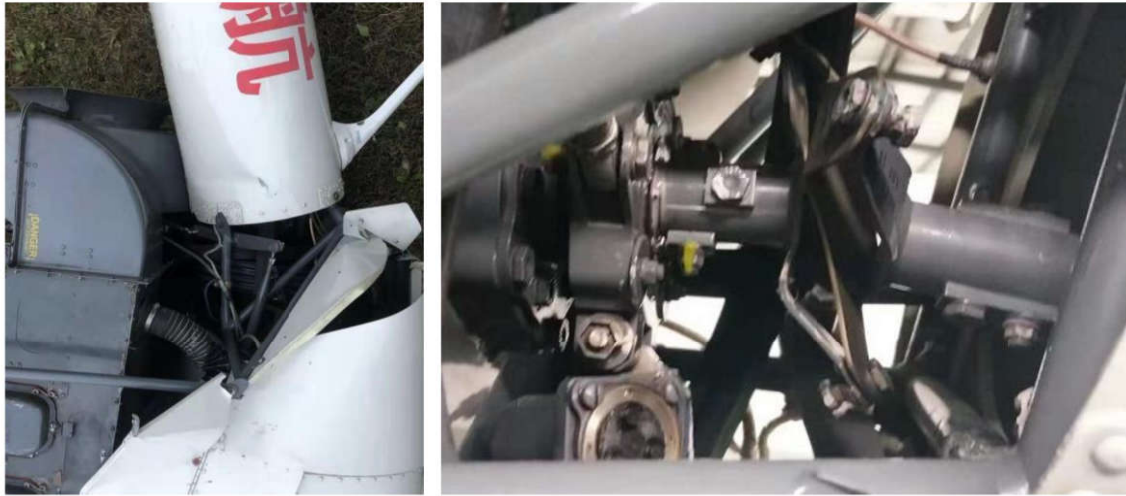
图 4 尾桨传动轴断裂图
