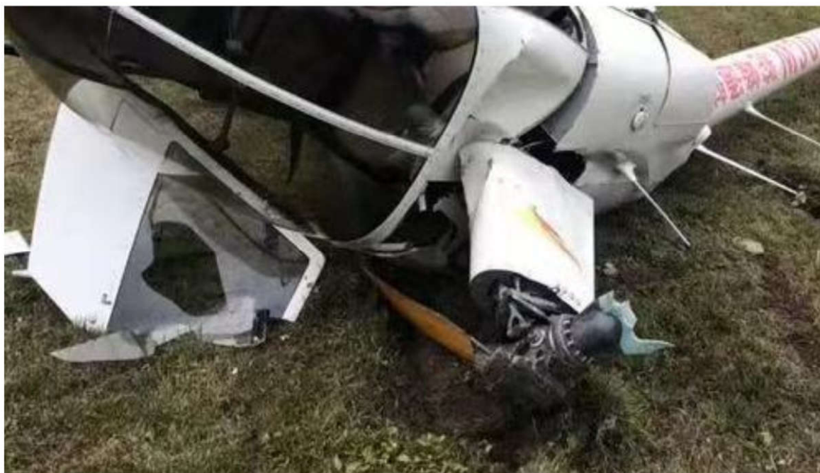
图 6 主旋翼断裂变形图
