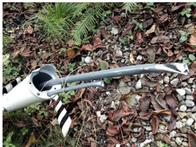
图 5：尾梁后段及传动轴断开掉落
