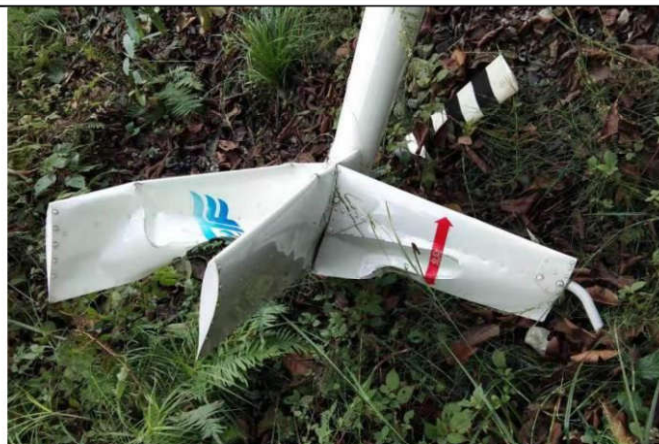
图 4：垂直尾翼形变损毁
