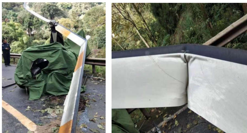
图 6：主旋翼断裂变形
