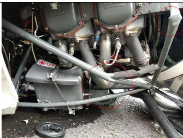
图 7：机体框架变形受损
