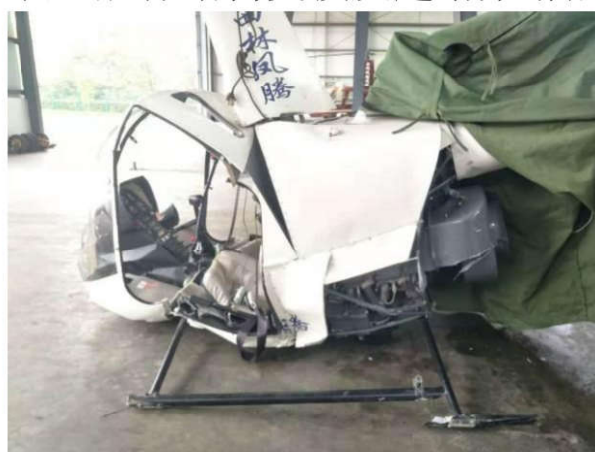
图 9：风挡完全破损、舱体变形损毁
