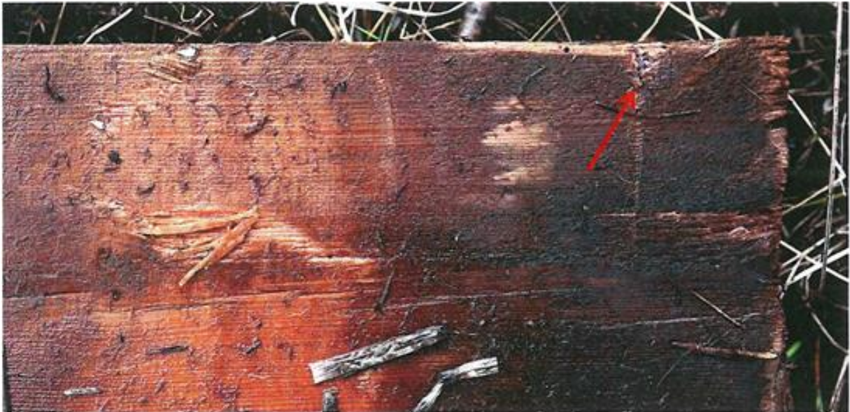
Figur 3. Närbild på undersidan av den lossade tvärslån. Av SHK infogad pil visar färgavskrap med samma färg som helikopterns landningsställ. Foto: Polisen.
