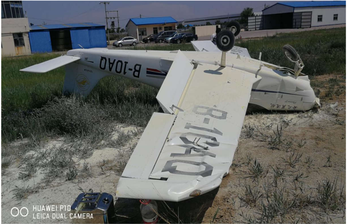
图 1: 整体损坏情况
