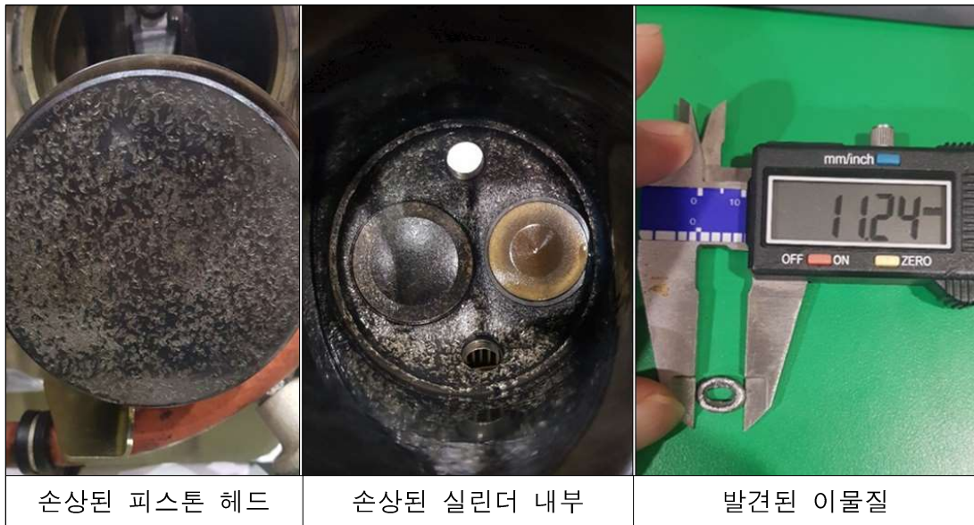
[그림 24] 손상된 5번 실린더 및 발견된 이물질
