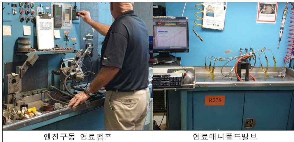
[그림 34] 엔진 연료부품 벤치테스트
