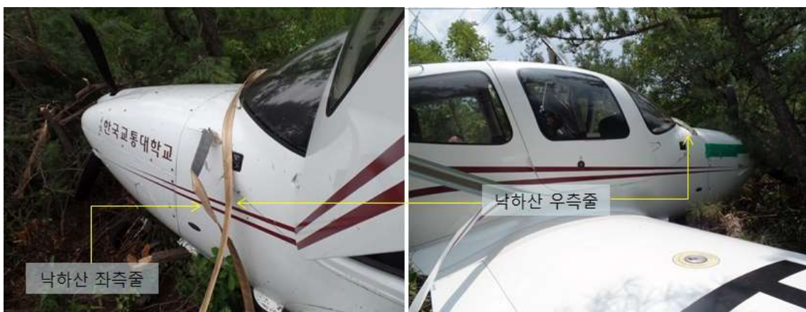
[그림 14] 비상낙하산 줄(좌우측)에 의한 기체외부 손상부위
