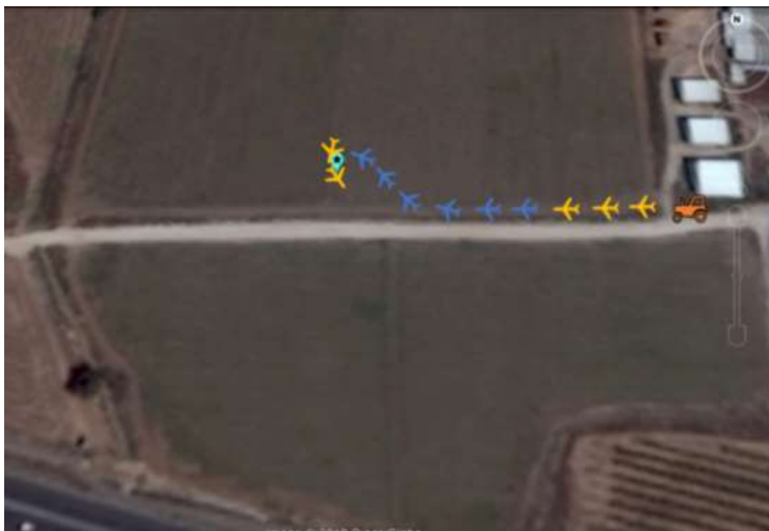
ריצת ההמראה (צהוב), לאחר הניתוק (כחול) הפגיעה בקרקע ועצירת המטוס (צהוב)
