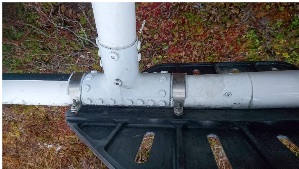
Figur 5. Höger bear paw som fastnade i en tuva. Bilden visar plattan med nitar som hindrar plattan från att vridas mer än ungefär 20 grader medurs.
