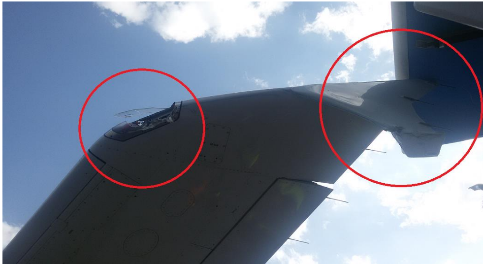
Slika broj 1.7. Oštećenja kraja lijevog krila i pozicionog svijetla
