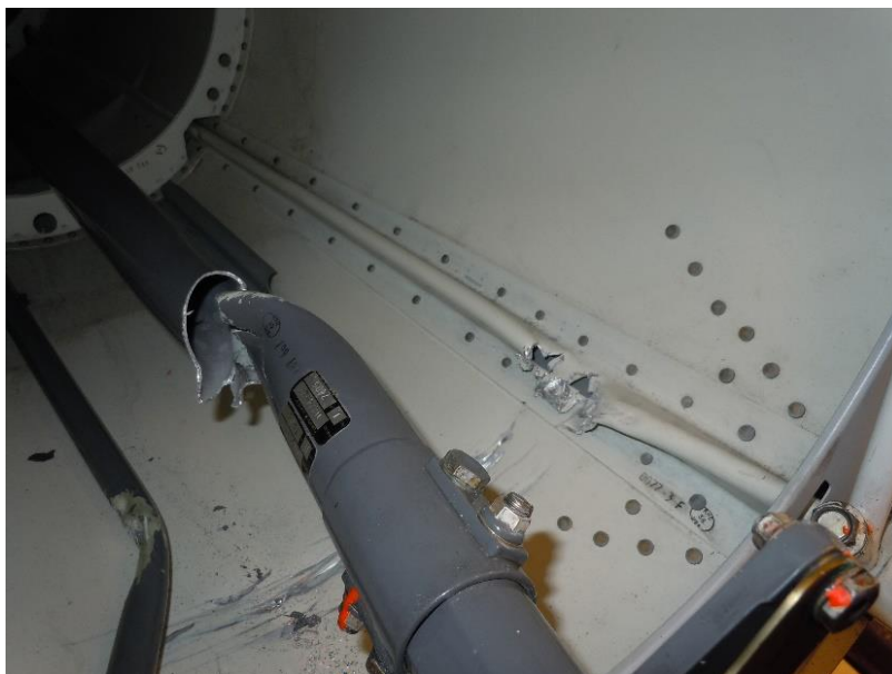
Figur 3. Skador på stjärtrotoraxel. Foto: Walthers Flygservice.
