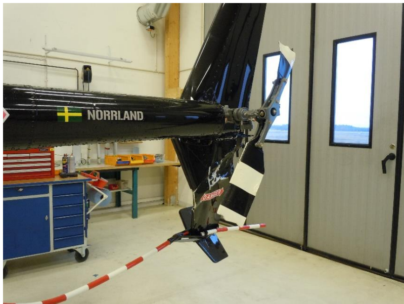
Figur 2. Skador på stjärtrotorblad. Foto: Walthers Flygservice.
