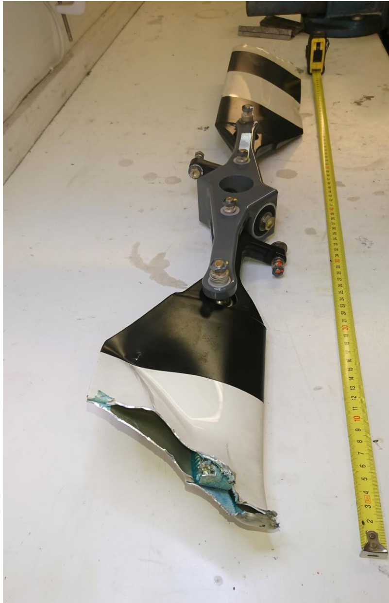
Figur 5. Skador på stjärtrotorblad. Foto: Walthers Flygservice.
