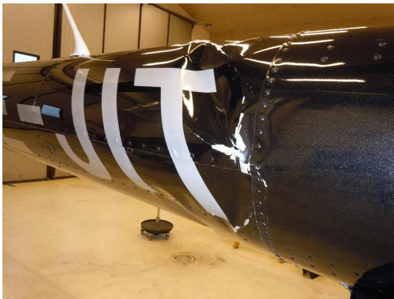
Figur 4. Skador på stjärtbommen. Foto: Walthers Flygservice.
