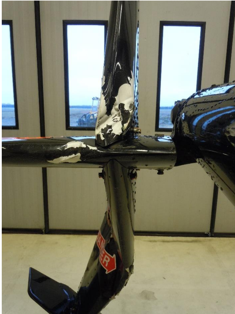
Figur 1. Skador på stjärtfenan. Foto: Walthers Flygservice.
