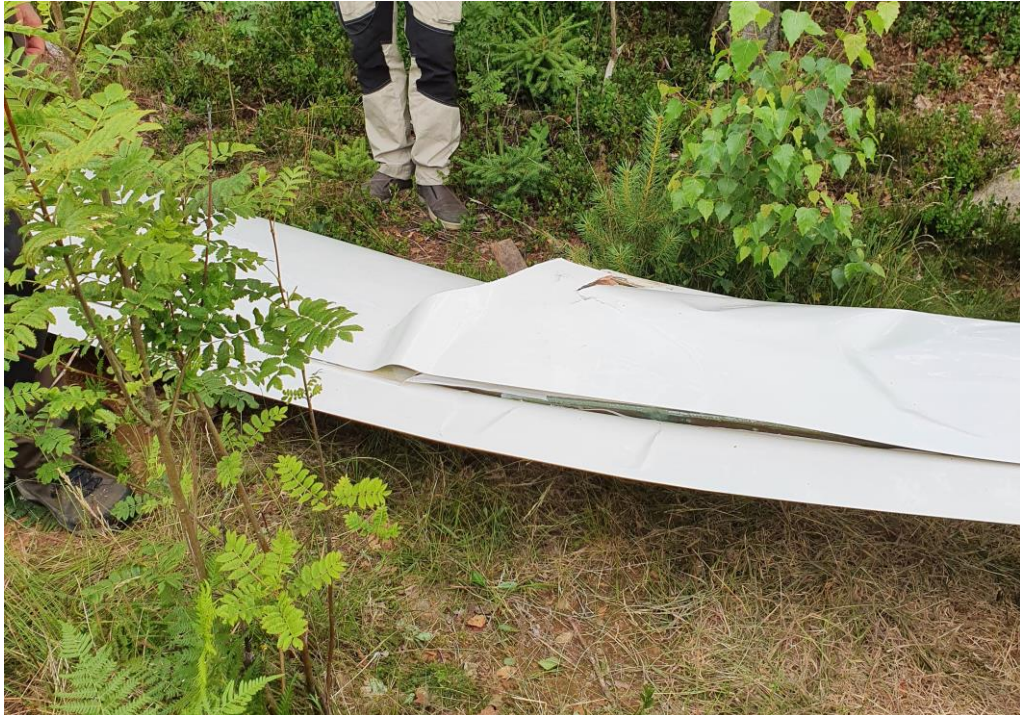
Figur 12. Skador på höger vinge. Foto: Christer Engdahl.
