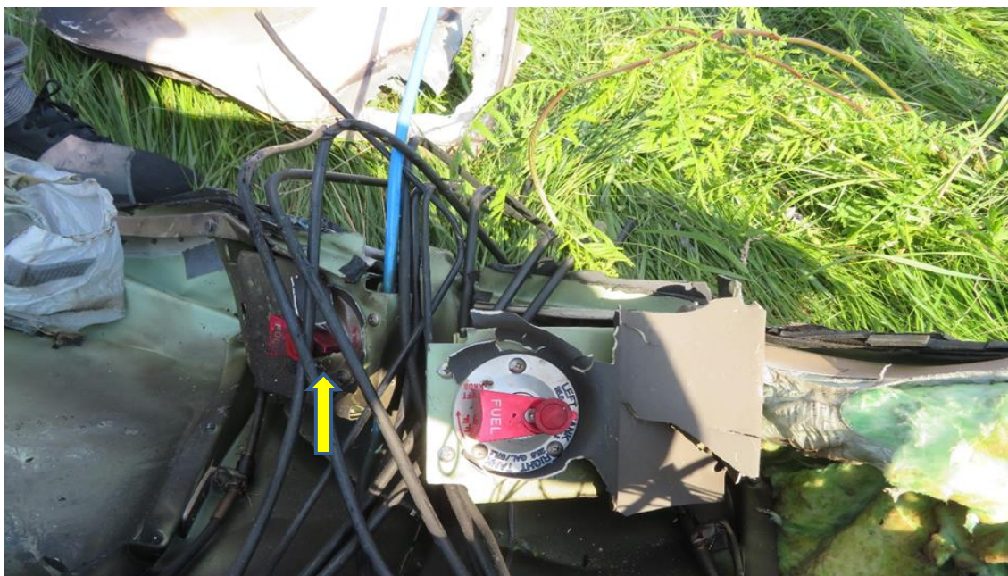
Rys. 8. Widok zaworu paliwa silnika nr 2 w położeniu zamkniętym [źródło: PKBWL]
