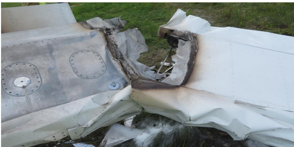
Rys. 5. Widok rozerwanej i zdeformowanej części konstrukcji lewego skrzydła [źródło: PKBWL]
