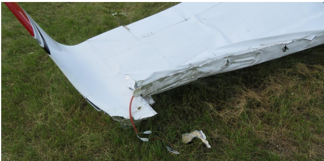
Rys. 4. Płaskie uszkodzenia na krawędzi natarcia skrzydła [źródło: PKBWL]
