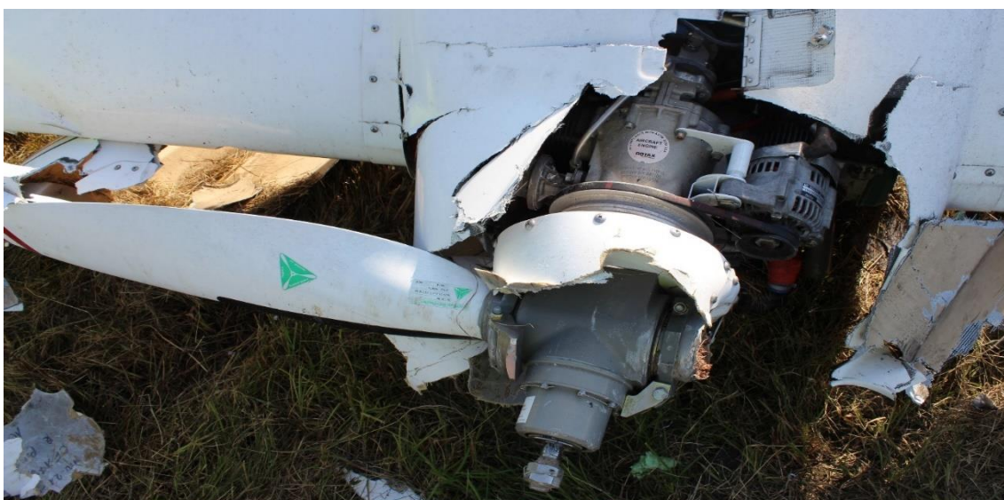
Rys. 7. Widok uszkodzeń zespołu napędowego nr 2 [źródło: PKBWL].
