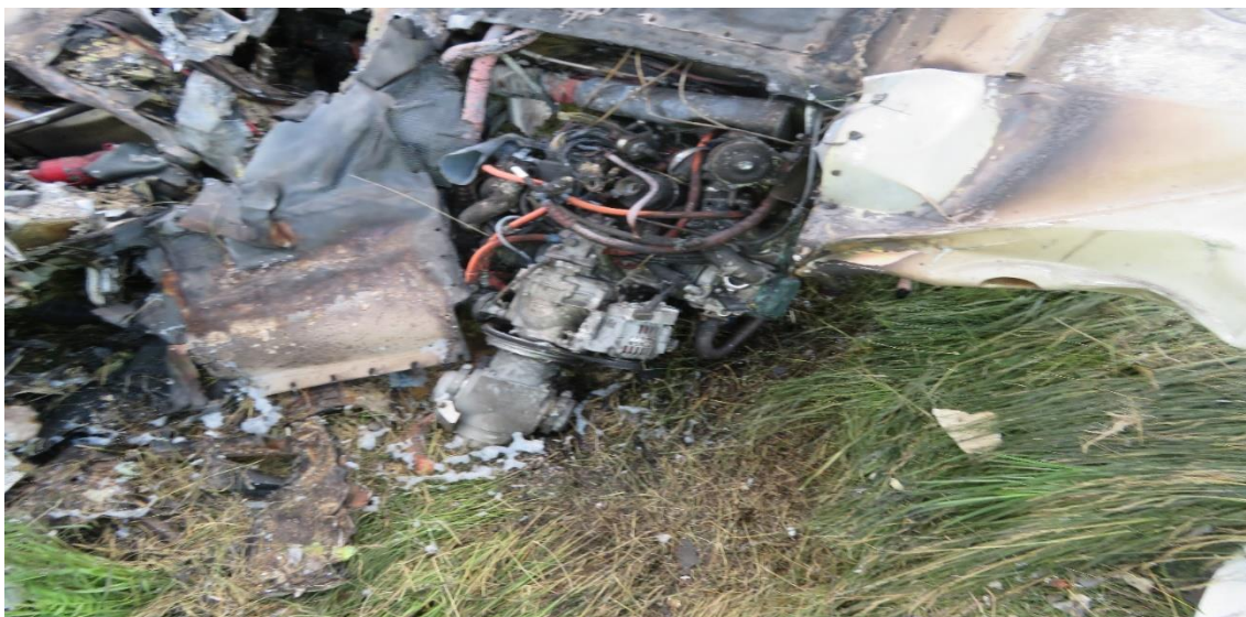
Rys. 6. Widok uszkodzeń zespołu napędowego nr 1 [źródło: PKBWL]
