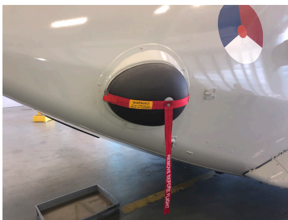
Figuur 3, links: Positie van de RBA aan de buitenzijde van het referentietoestel. Figuur 4, rechts: De RBA bij overname op de marinebasis Parera. (Bron: Onderzoeksraad voor Veiligheid)
