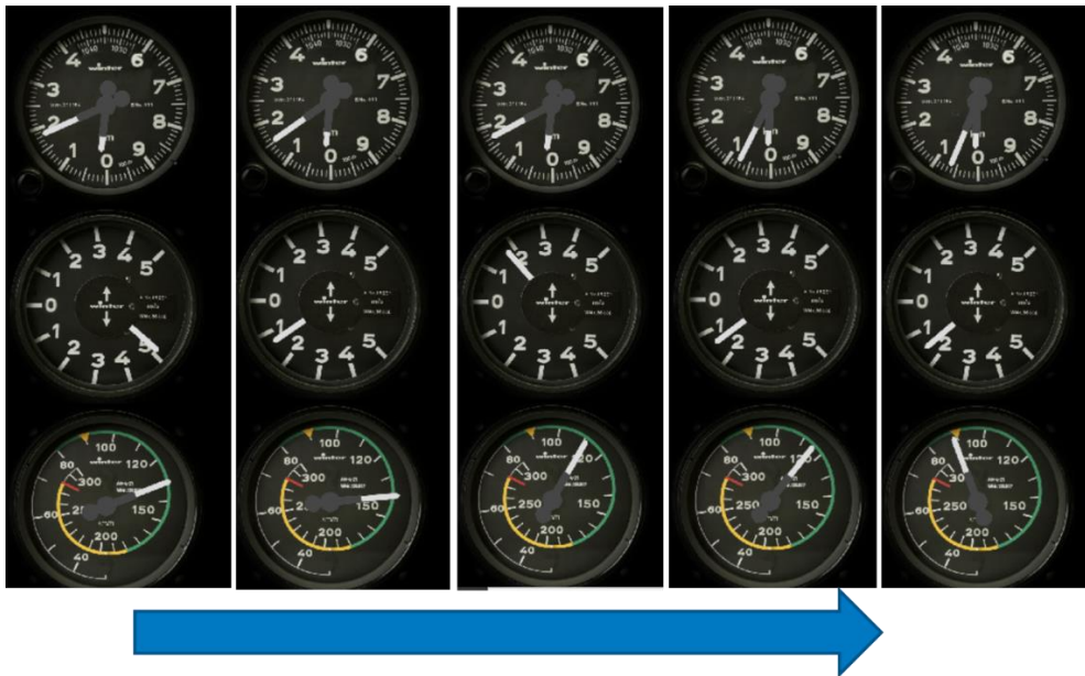
Figur 2. Fem ögonblicksbilder av höjden (i meter), sjunkhastighet (i meter per sekund) och farten (i km/tim) under de sista 150 metrarna. Visar endast beräknade värden från GPS-position och höjd över tid.
