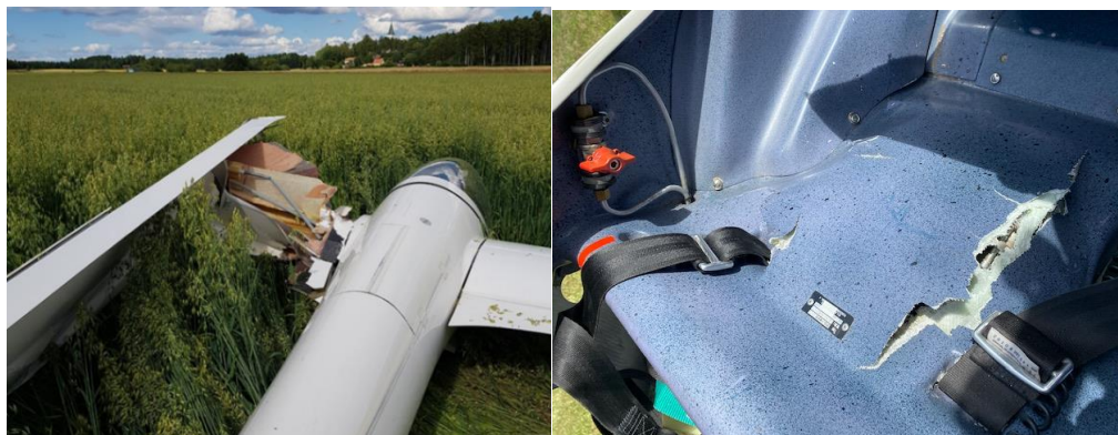
Figur 4. Strukturella skador på vänstervingen och i cockpit. Foto: Piloten (vänster) och Kjell Magnusson (höger).
