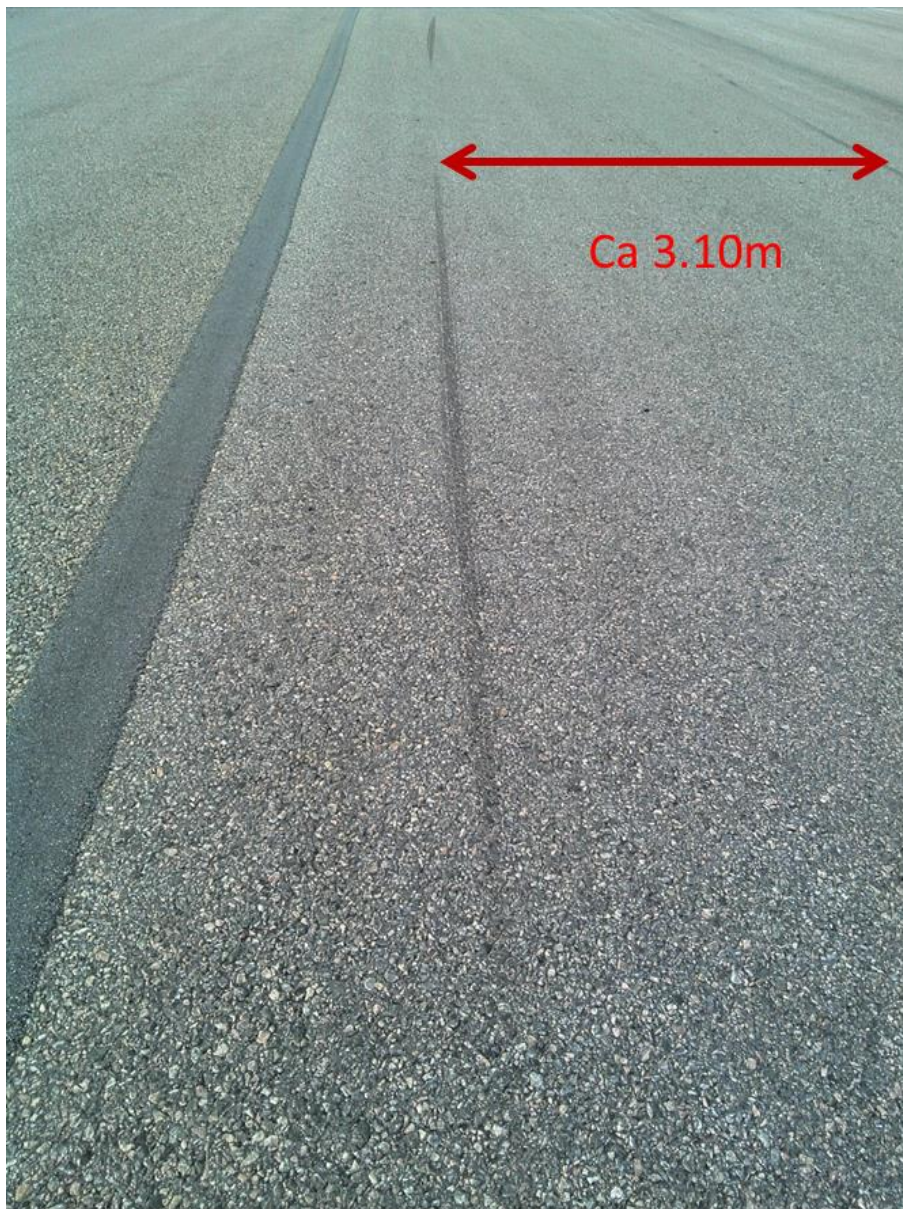
Figur 17. Däckspår som bedöms härröra från händelsen. Avståndet mellan spåren överensstämmer med avståndet mellan höger och vänster hjul på en Piper PA-28.
