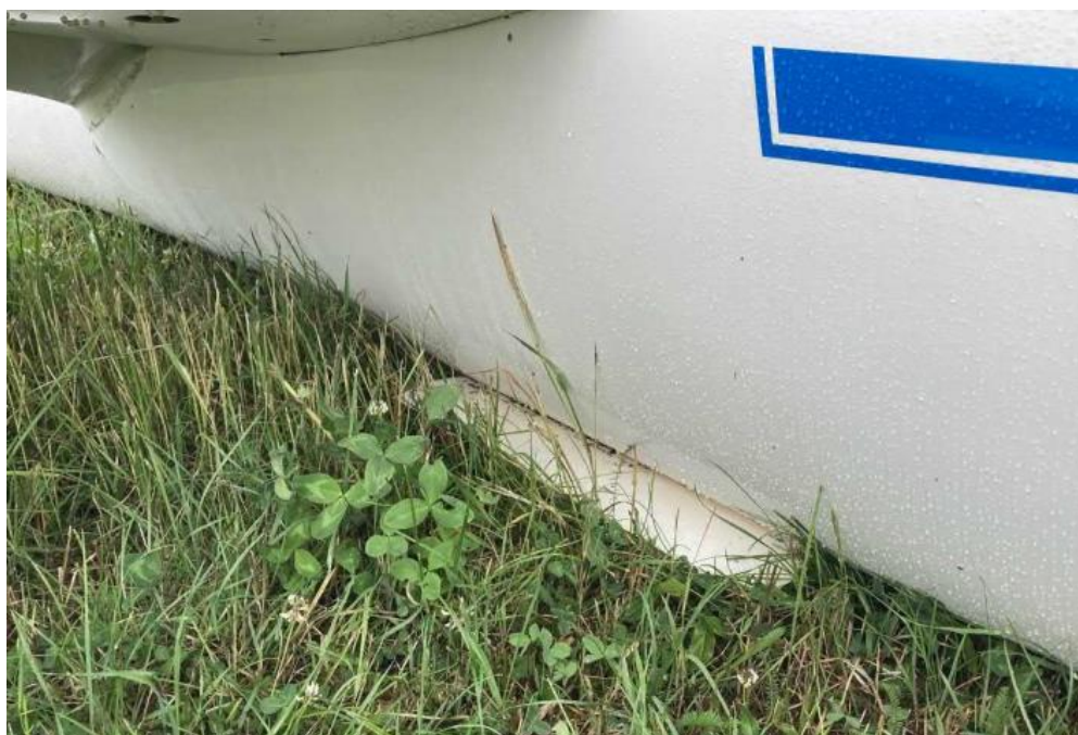
Figur 2. Landställsluckan utfälld. Foto: Mattias Johansson.
