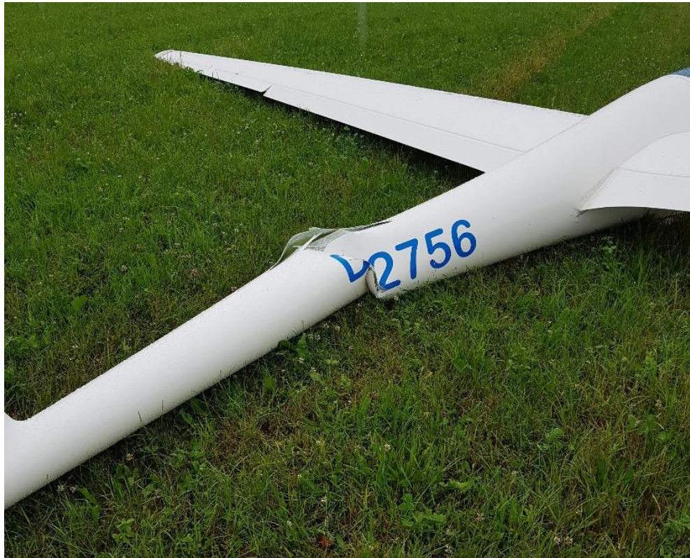
Figur 1. Skador på bakkroppen. Foto: Mattias Johansson.
