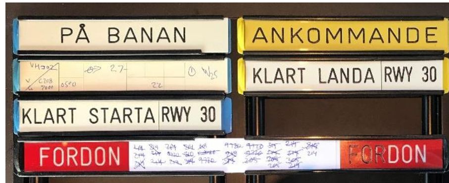
Figur 2. Flygledarens minnesbild av den relevanta delen av FPB (Cessnans stripp ligger ovanför Klart Starta). När en klarering för start ges ska strippen som representerar det aktuella flygplanet placeras under strippen KLART STARTA RWY30. Bana 30 var i användning, men med tanke på den ringa medvind som var på bana 12 föreslog flygledaren den banan i stället, vilket accepterades av cessenapiloten.
