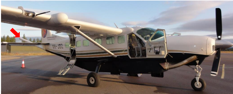
Figur 4. VH-JOZ på plattan på Arvidsjaur flygplats. Notera mätantennen bakom fenan markerad med röd pil.
